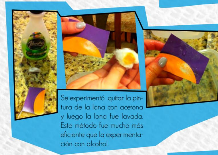
Se experimentó quitar la pintura de la lona con acetona y luego la lona fue lavada. Este método fue mucho más eficiente que la experimentación con alcohol.
