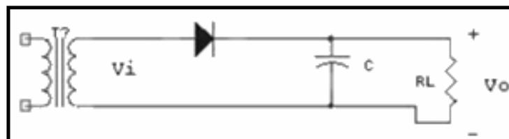
Figura 63. Filtro en conexión básica
