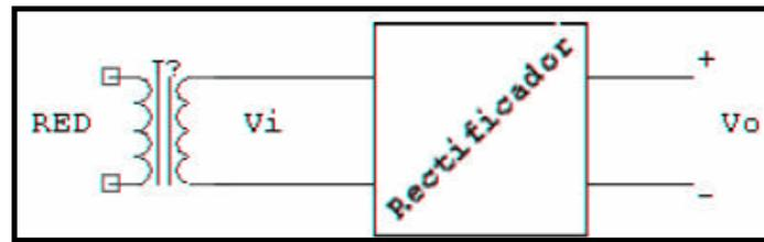
**Figura 60.** Conexión de un rectificador
