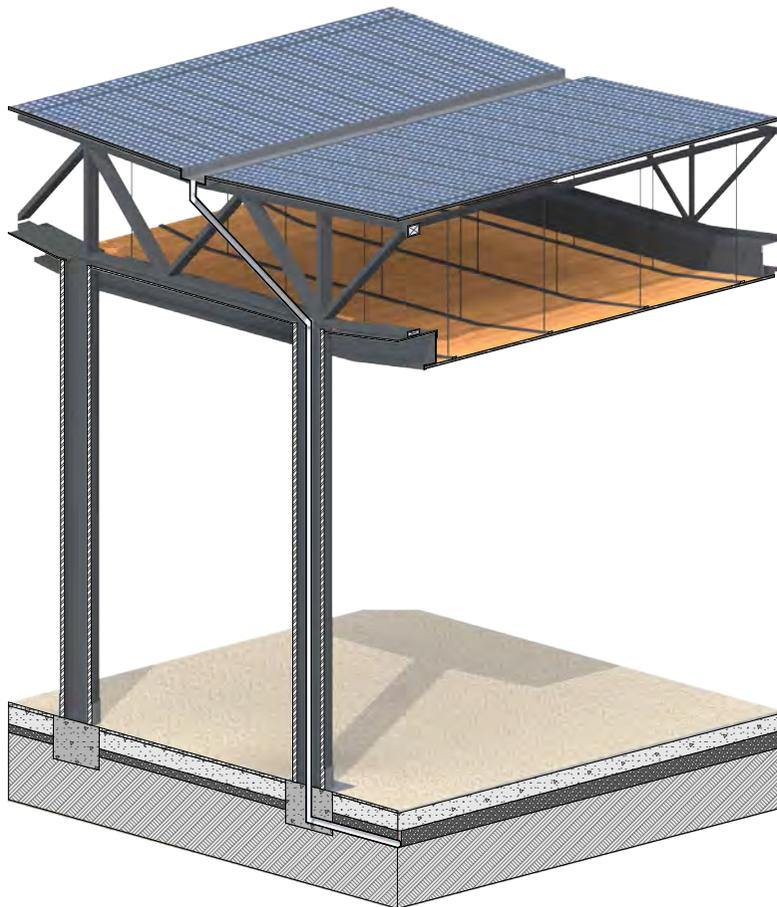
La cubierta esta construida con un panel auto portante que permite la aislación térmica y acústica, dejando una cámara de aire entre el cielo raso, permitiendo el paso de las instalaciones por la misma.
