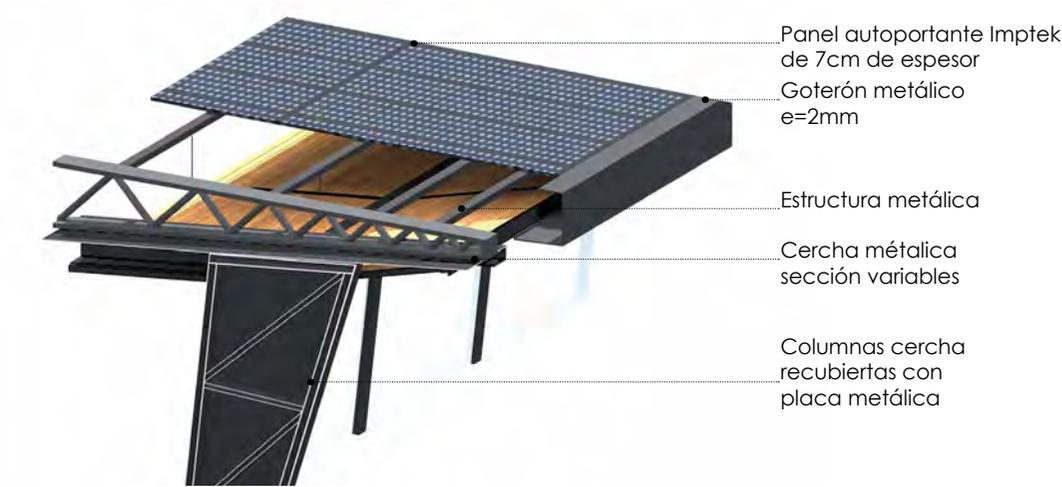
Detalle construcción cubierta 1
