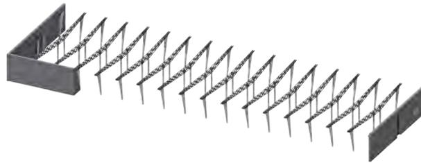
Fase 2.- Estructura principal de cerchas metálicas, y base en forma de C sobre las columnas.
