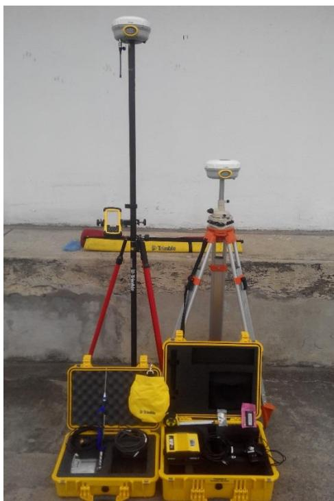
El proceso de medición de los puntos de control se desarrolló mediante un posicionamiento estático rápido, las mediciones fueron continuas, con épocas de 5 segundos, el período de observación varía entre 5 a 20 minutos dependiendo de ciertas condiciones que podrían afectar la precisión de los datos; el PDOP fue inferior a 3 y la máscara de elevación sobre los  $10^\circ$  con respecto al horizonte de la antena.
