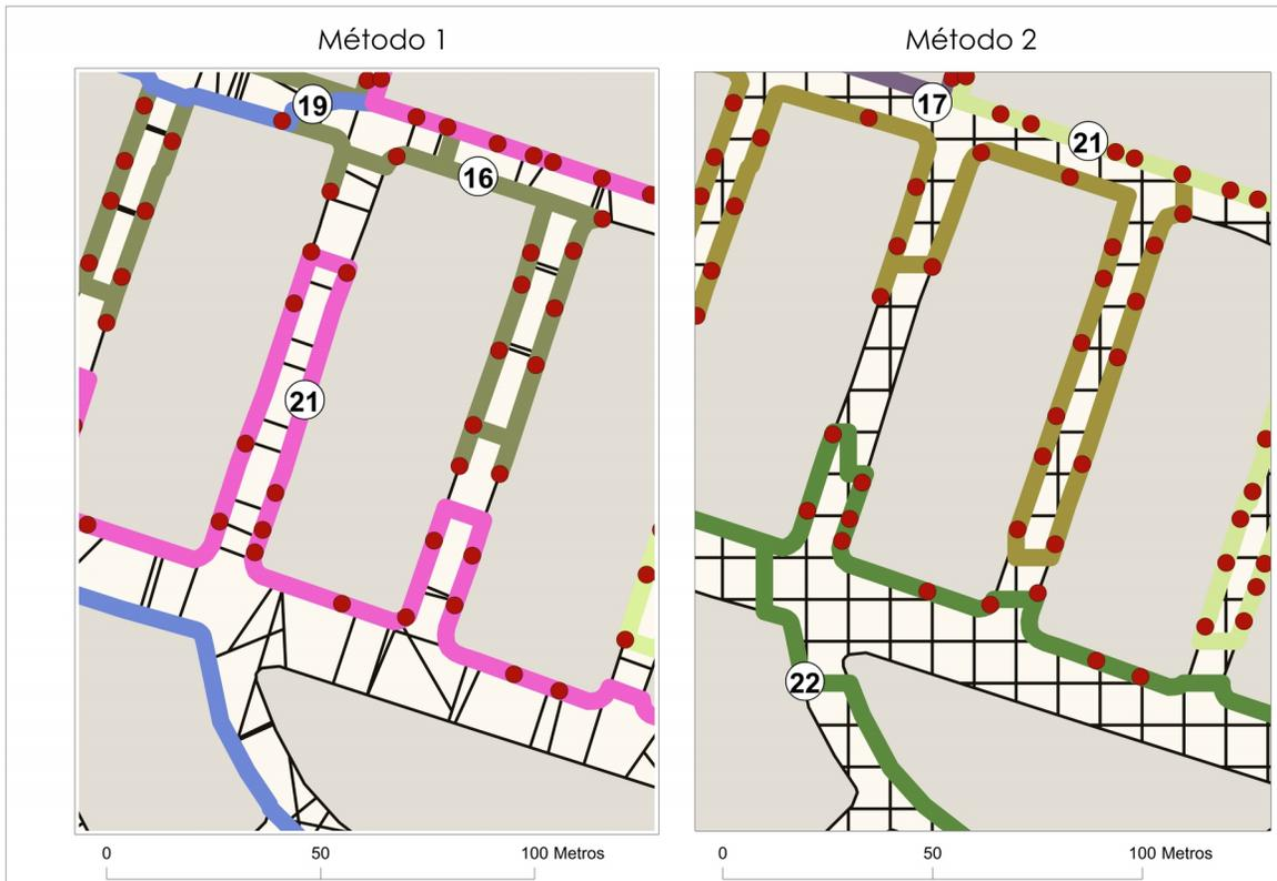
Figura 9.- Rutas óptimas generadas a partir de la red de perpendiculares: Método 1 (izquierda) y red con cuadrícula ortogonal Método 2 (derecha).
