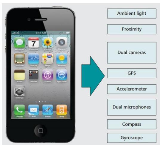
Figura 3: Sensores del dispositivo móvil iPhone 4s (Lane et al., 2010)
