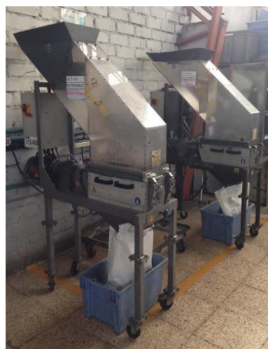
Figura 18 Molinos para triturar el material no conforme
