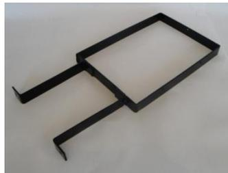
La sección de prueba está formada por vidrio, se utilizan 4 vidrios unidos por silicón; el vidrio superior tiene un corte para ingresar los objetos a la cámara de estudio. Se construyen 2 soportes rectangulares con perfiles de aluminio, figura 3.7, en forma de T, para sujetar el vidrio al cono de contracción y al difusor.
