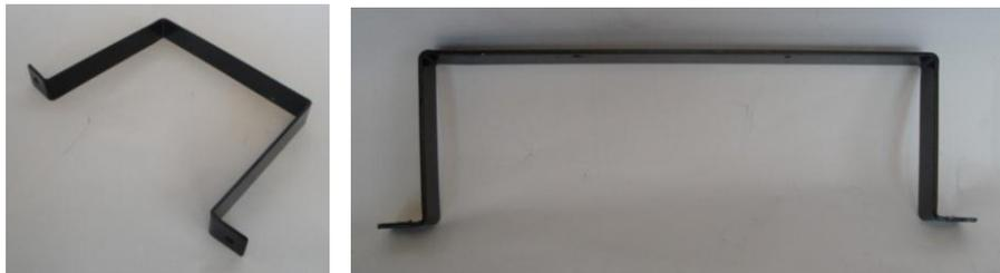
Toda la estructura se sujeta a una madera de plywood de 12mm de espesor, mediante los soportes de platina y pernos, figura 3.12.
