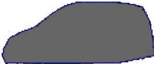
Se utiliza poliestireno, conocido como espuma flex, para construir el perfil; se corta un pedazo, luego con una cuchilla se va dando forma hasta que se asemeje al perfil construido en Autocad, se pasa con lija para pulir la superficie. Se pinta de color azul para facilitar la visualización del humo.
