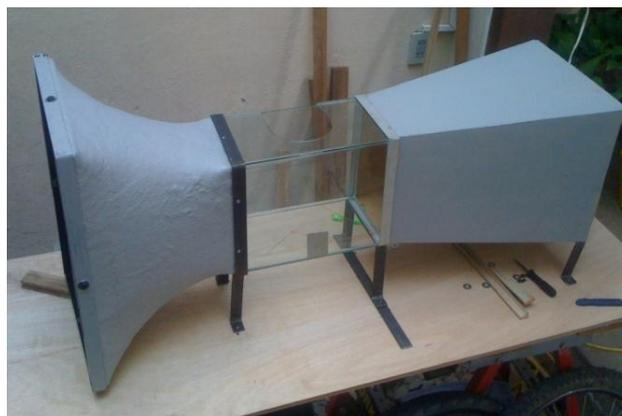
La entrada de humo se une a la maquina mediante un tubo en forma de cono hacia un tubo PVC de 2plg, figura 3.13.
