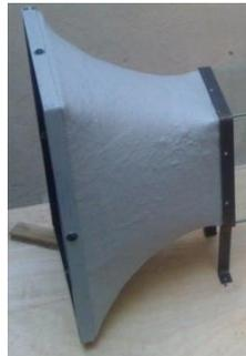
Se prepara pintura color azul y se aplica a todo el cono de contracción, se indica en la figura 3.5.
