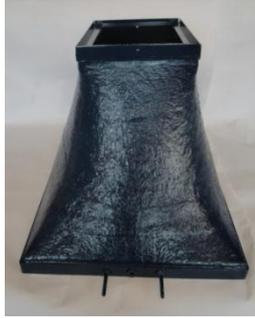
Para sujetar el cono de contracción se hace 2 soportes metálicos con platina de 1pulg. Estos soportes permiten sujetar el cono de contracción a la madera, además de apoyos para toda la estructura de la maqueta.
