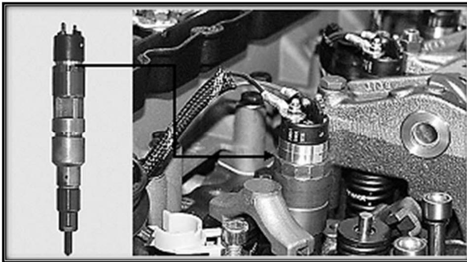
Figura 2.9 Disposición de los inyectores
