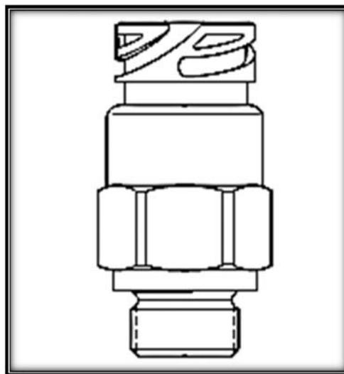
Figura 2.19 Sensor de la presión de combustible
