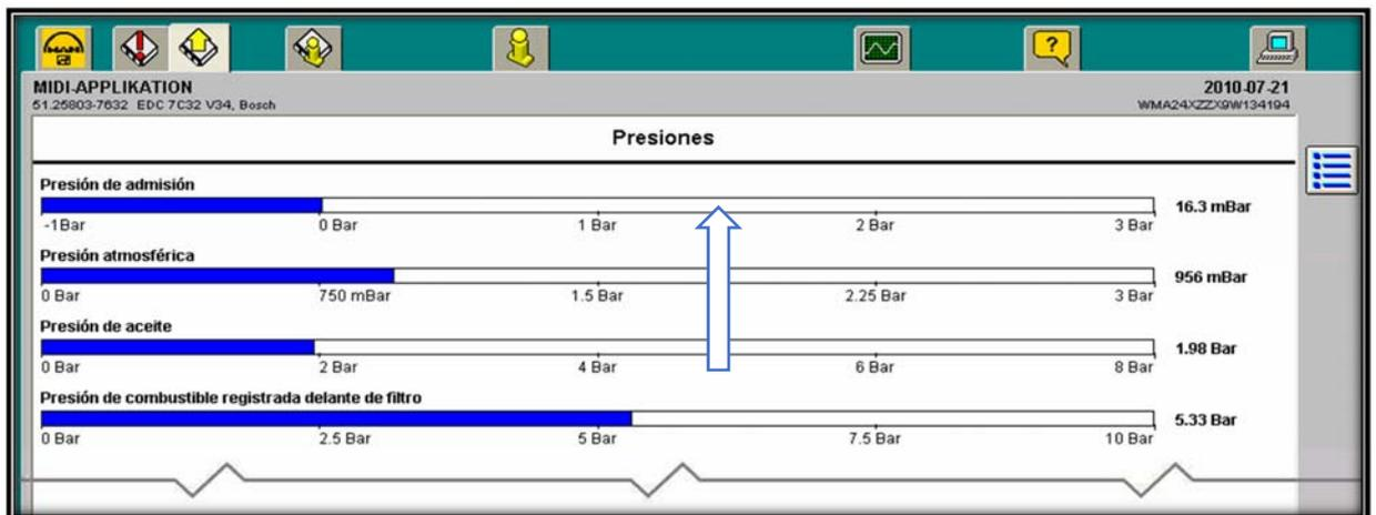
Figura 3.10 Medición de presión de admisión en el motor.
