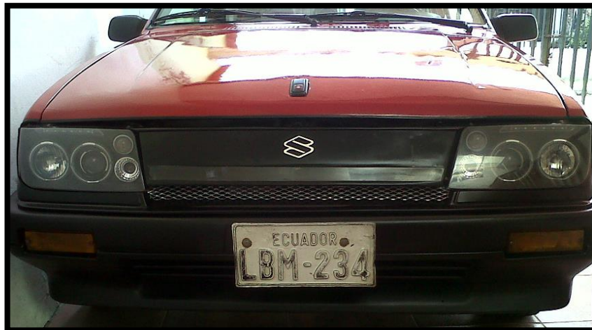
Figura 4.3: Instalación de la Mascarilla y Faros.
