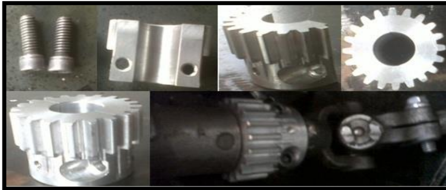
Figura 4.5: Estructura y Montaje de la Rueda Dentada de Aluminio.
