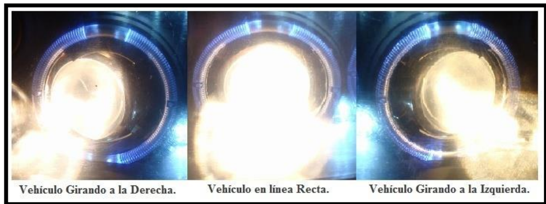
Figura 5.15: Giro de los Faros según la Dirección del Vehículo.
