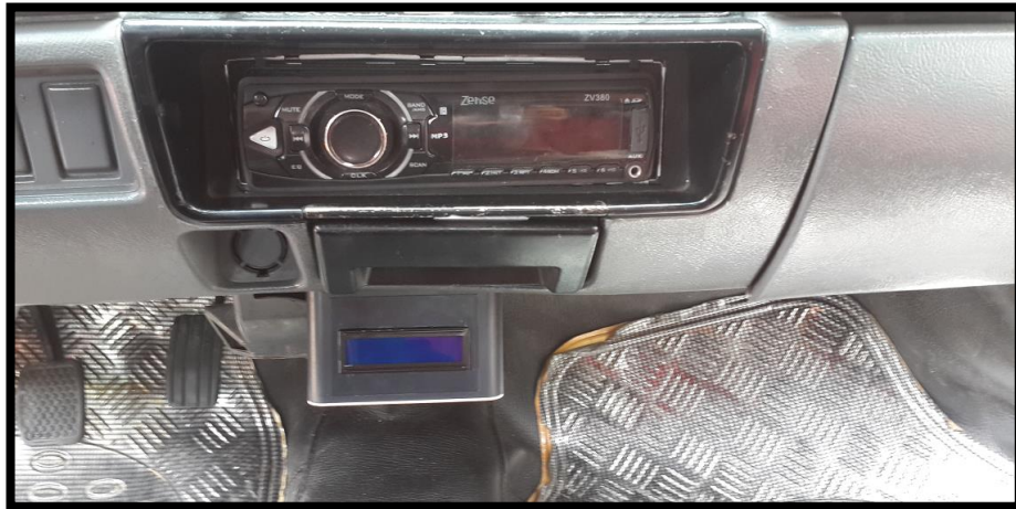
Figura 4.10: Montaje del Display de Información.
