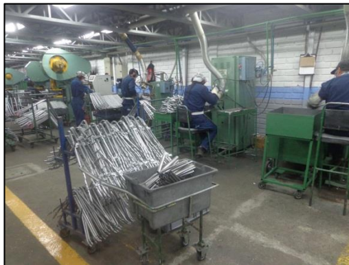
Figura 19. Tubos de combustión terminados.
