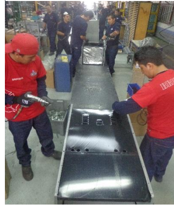
Figura 22. Armado de laterales de una cocina.
