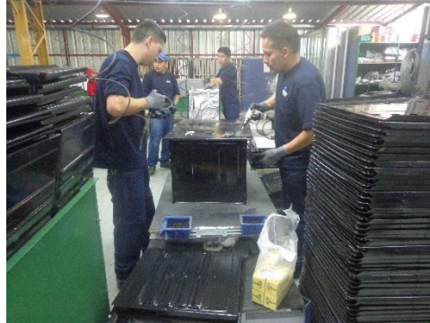
Figura 23. Armado de cuadro del horno de una cocina.
