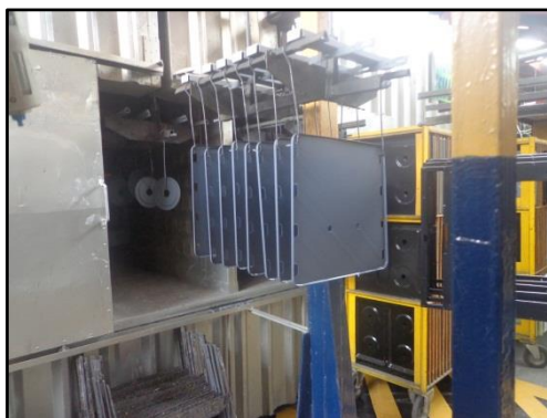
Figura 15. Ingreso de material enlozado a horno.
