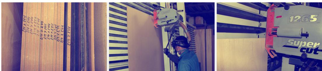
**Figura 23.** Optimización de material – máquina escuadradora
