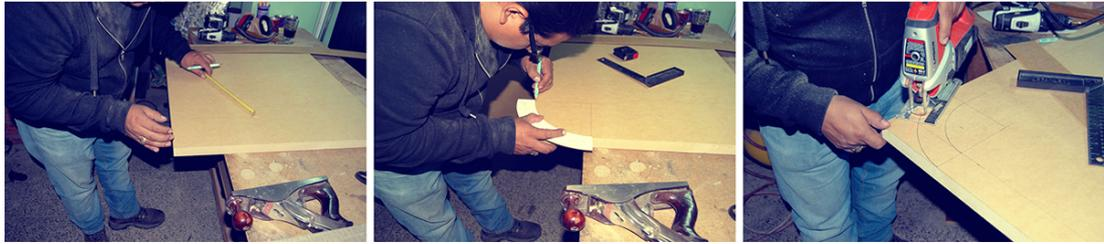
**Figura 24.** Proceso de cortado manual
