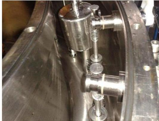
**Figura 8: Válvula de llenado, empaques deteriorados**
