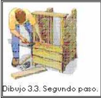
2.- Se construyen los otros laterales, se apoyan en una pared y se colocan de modo que queden paralelos, como sujeción momentánea se clava una madera que inmovilice ambos postes, y se levanta la parte trasera.
