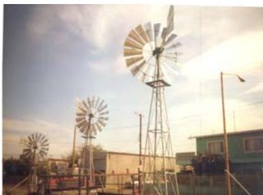
Altura variable (10 –15 m), y va proporcional al tamaño de la rueda; a mayor tamaño de la rueda, mayor altura. Sus dimensiones varían según el anclaje, necesidades de agua y profundidad de bombeo. Es importante, que las aspas queden a 5 m. de altura, sobre los obstáculos que se encuentren a 120 m. a la
