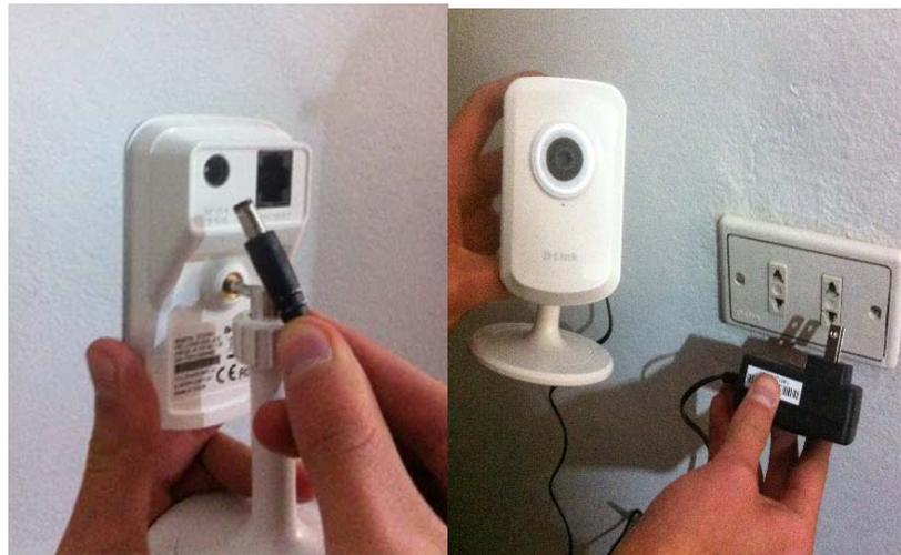
Fig.6.2.2. Conexión Cámara IP
