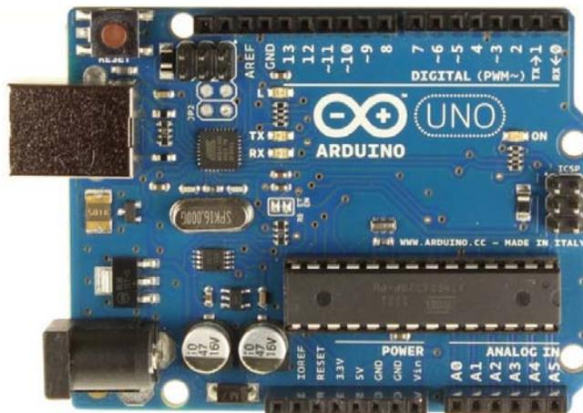
Fig.3.1.3 Placa Arduino
