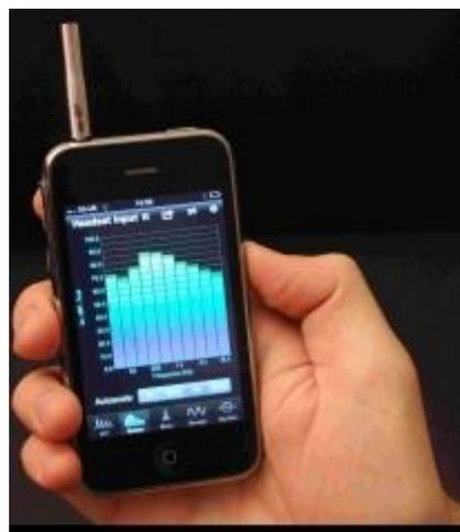
Figura 4.3. Dispositivo móvil equipado con micrófono externo marca Barma Fuente: [http://www.instalia.eu/es/notices/2012/05/barma\\_profesional\\_audio\\_inicia\\_la\\_distribucion\\_de\\_una\\_nueva\\_marca\\_de\\_microfonos\\_micw\\_especializada\\_e\\_2253.php](http://www.instalia.eu/es/notices/2012/05/barma_profesional_audio_inicia_la_distribucion_de_una_nueva_marca_de_microfonos_micw_especializada_e_2253.php)
