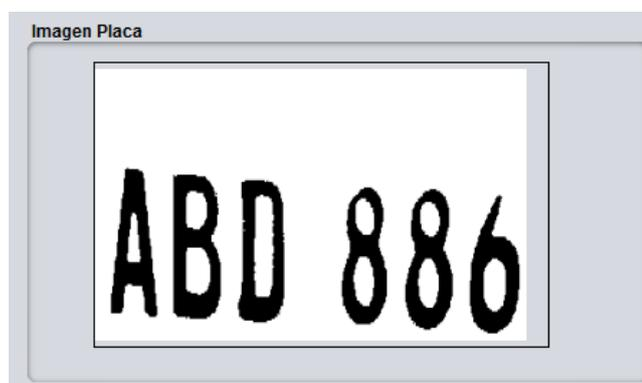
Figura 6.108 Placa binarizada con diferente tipografía.
