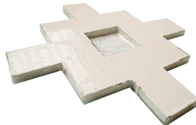
CONTENEDOR DE VIDRIO Y CAUCHO DE SILICONA - ETAPA DE SECADO DEL MATERIAL
