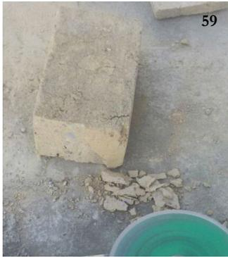
(Ancho) Al 1cm la pieza se trituró por completo. No se pueden realizar cortes de un centímetro o menos.
