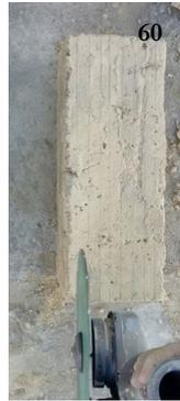
(Largo) Al 1cm la pieza se trituró por completo. No se pueden realizar cortes de un centímetro o menos.
