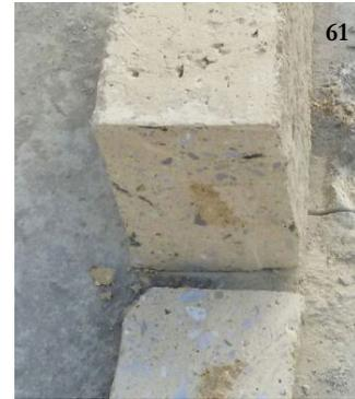
(Ancho) A los 2cm la pieza ya no sufre fisuras al ser cortada, mientras está totalmente seca.
