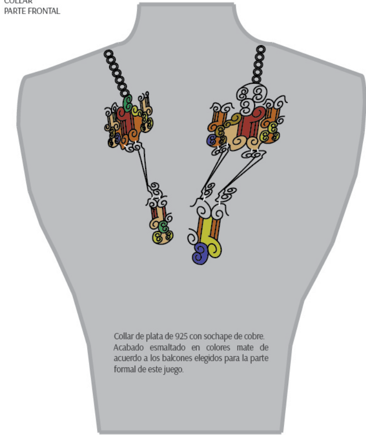
Collar grande de plata y sochape de cobre de 1.5mm. Formados por módulos que se unen mediante asas que permiten movilidad.
