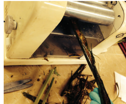
Fig. 2.118 Trituración de totora con maquina de rodillos.
