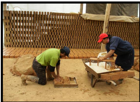
Foto5. Proceso de Moldeado
