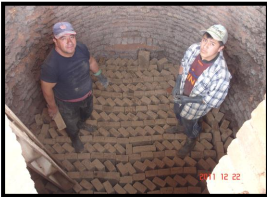
Foto 9. Distribución de ladrillos para la quema
