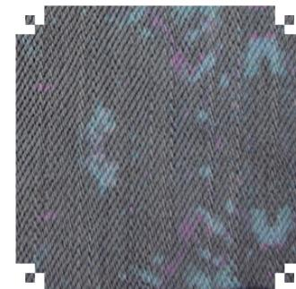
Tab154. Denim ensayo de frote húmedo
