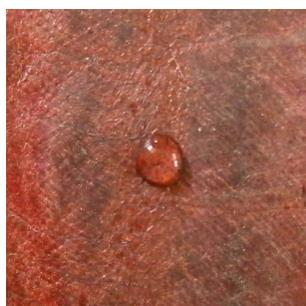
**3. RESISTENCIA ALTA:** cuando no existe daño alguno en la piel, pues la gota se mantiene en la superficie sin penetrar.
