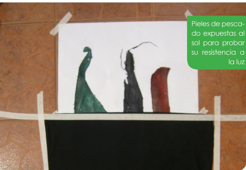
Al no existir variación del color luego del examen físico de resistencia a la luz solar, se toma en cuenta como si todas las pieles analizadas poseen buena resistencia a este factor, razón por la cual no existen Criterios de Valoración en este examen para realizar una comparación en base a los tres niveles tomados en cuenta en los otros análisis.
