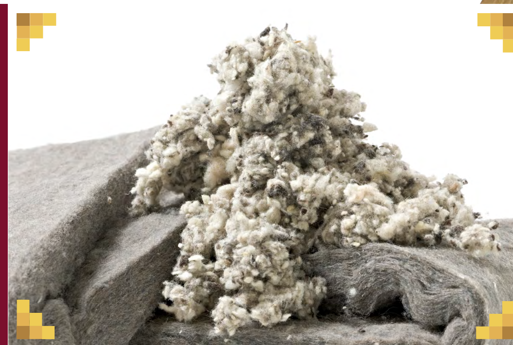
Figura 19. Aislante hecho a bases de lana de oveja, para hacer paneles en construcciones.
