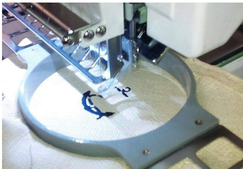
3 Se procede a bordar colocando el pellón en la parte inferior.
