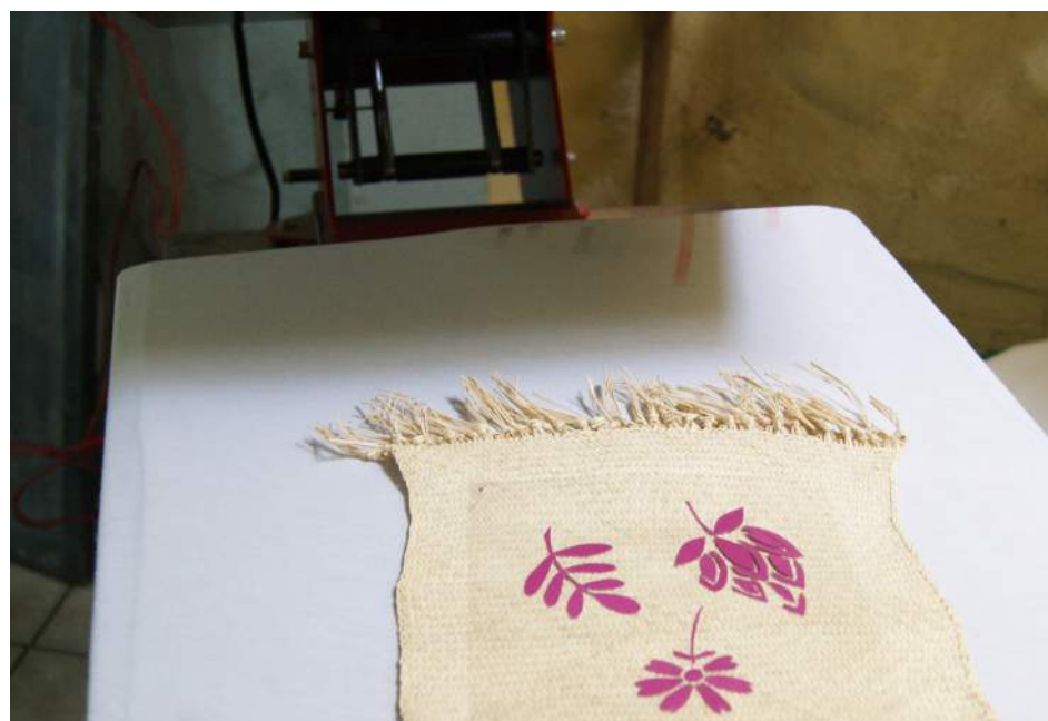
3 Colocar el tejido y el diseño impreso en la plancha a una temperatura de 170 grados centígrados y cerrar la plancha por un tiempo de 25 segundos.
