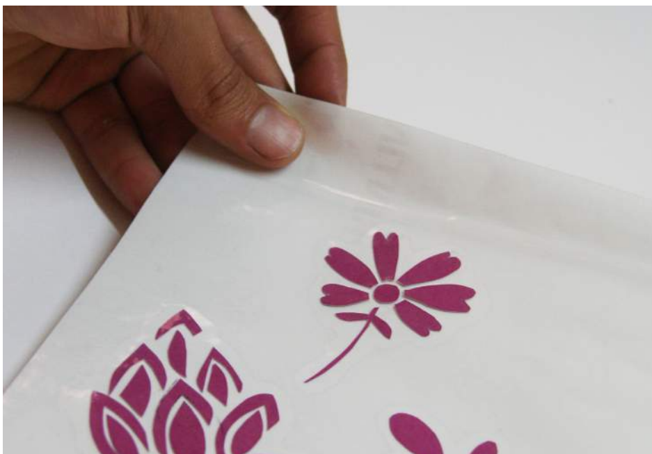
1 Cortar el vinil en el plotter con el diseño establecido.
