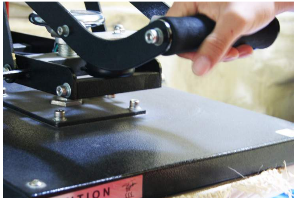
8 Se coloca en la plancha por un tiempo de 8 segundos a una temperatura de 180 grados centígrados.
