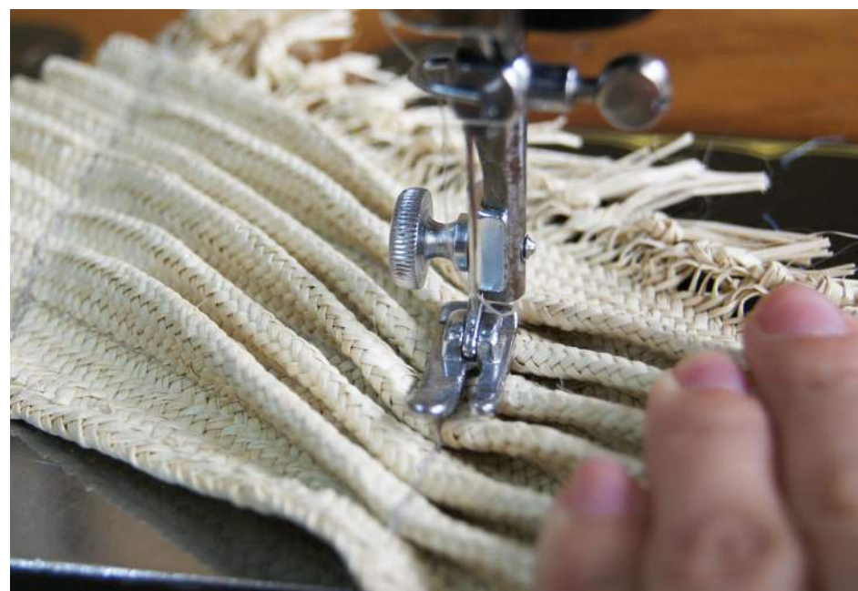
10 Coser por las líneas trazadas con los pliegues de la textura hacia arriba para lograr una textura de líneas discontinuas.
