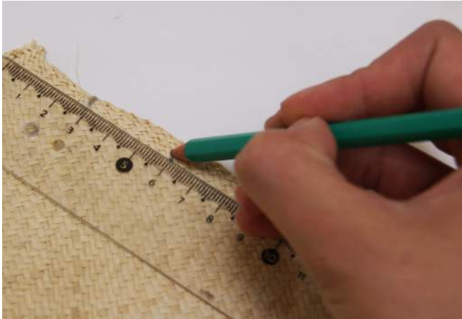
1 Trazar dos líneas paralelas en los bordes del tejido.
