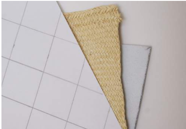
11 Colocar los tres materiales juntos para proceder al cosido en el siguiente orden: lámina rígida, tejido de paja toquilla y papel con el patrón marcado hacia arriba.
