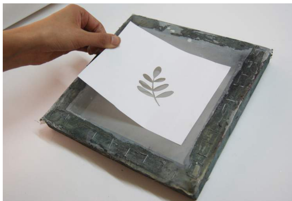
3 Se coloca y adhiere al bastidor.
