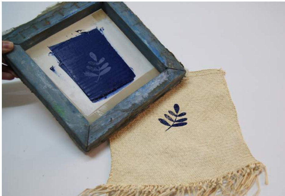
7 Se retira el bastidor.
