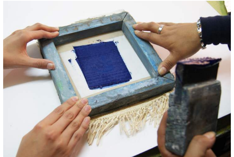
6 Se pasa una paleta con la tinta sobre la malla, ejerciendo presión sobre ella.
