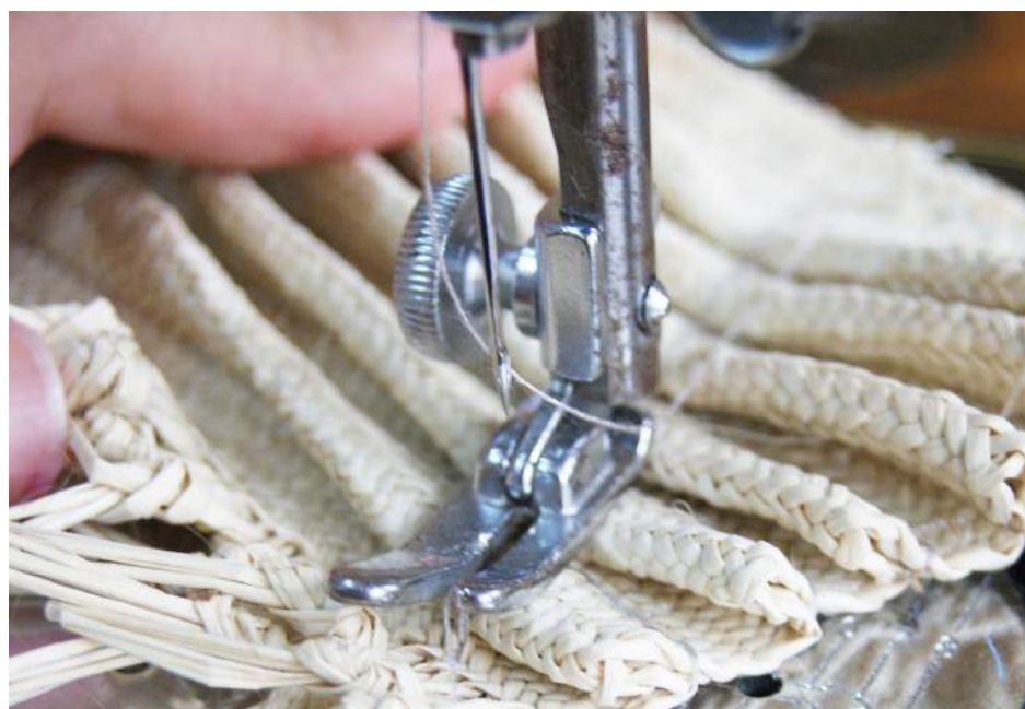
9 Coser por las líneas trazadas con los pliegues de la textura hacia abajo.
