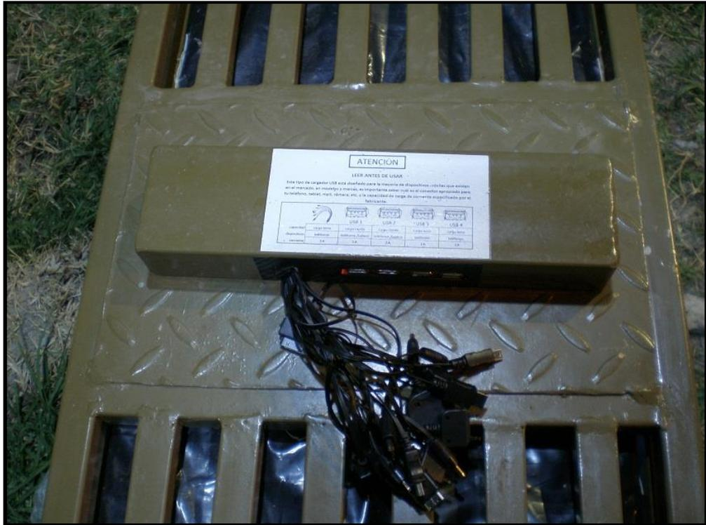
Figura 4.7 Módulo que entrega la energía DC a diferentes dispositivos, este se encuentra por encima de la banca.
