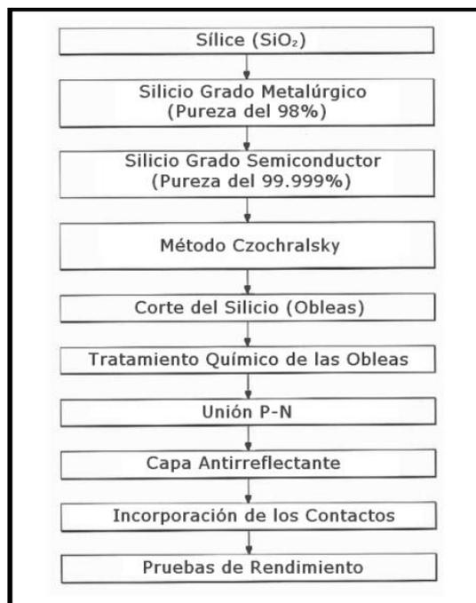
Figura 1.3 Pasos para la creación de una Célula Solar Monocristalina.
