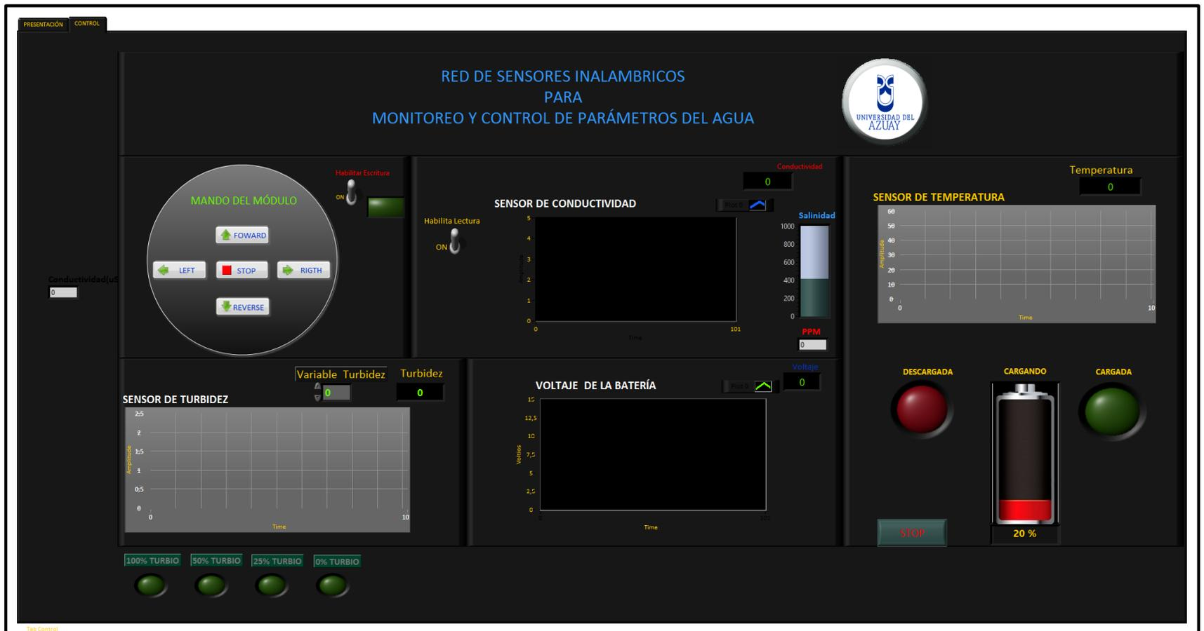
Figura 3.42. Panel frontal, monitoreo y control de parámetros del agua en una red de sensores inalámbricos.
