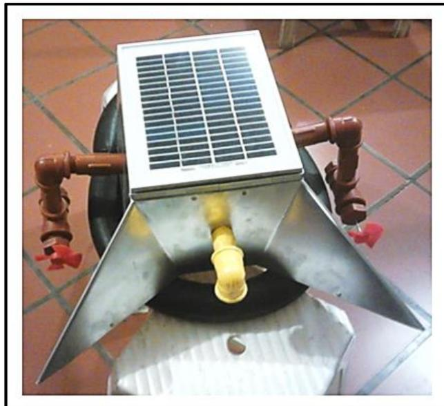
Figura 3.33. Ensamblaje del panel solar en la estructura del chasis, del módulo móvil acuático.
