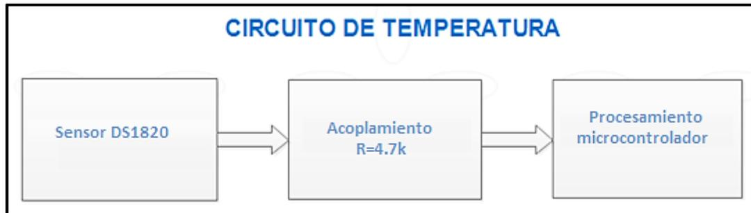
Figura 2.4. Esquema de acondicionamiento del circuito de Temperatura.
