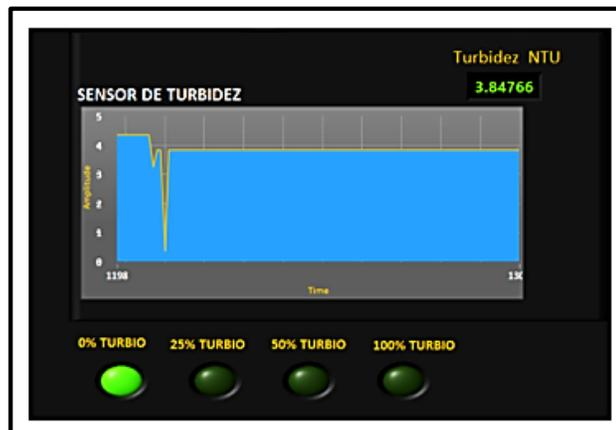
Figura 4.36. Medición de Turbiedad en LabVIEW, tanque de Almacenamiento.
