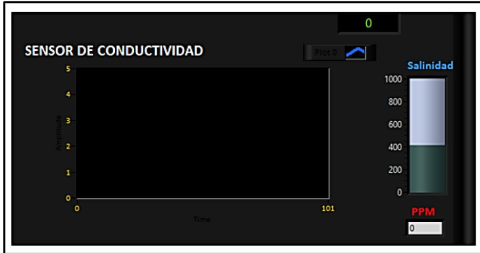
Figura 3.45. Panel frontal, nivel de conductividad y salinidad del agua.
