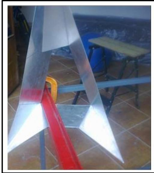
Figura 3.30. Corte de la plancha de hierro galvanizado, estructura del chasis.
