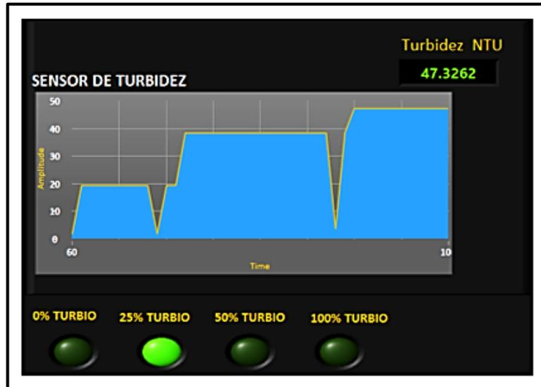
Figura 4.41. Medición de Turbiedad en LabVIEW, laguna Toreadora.
