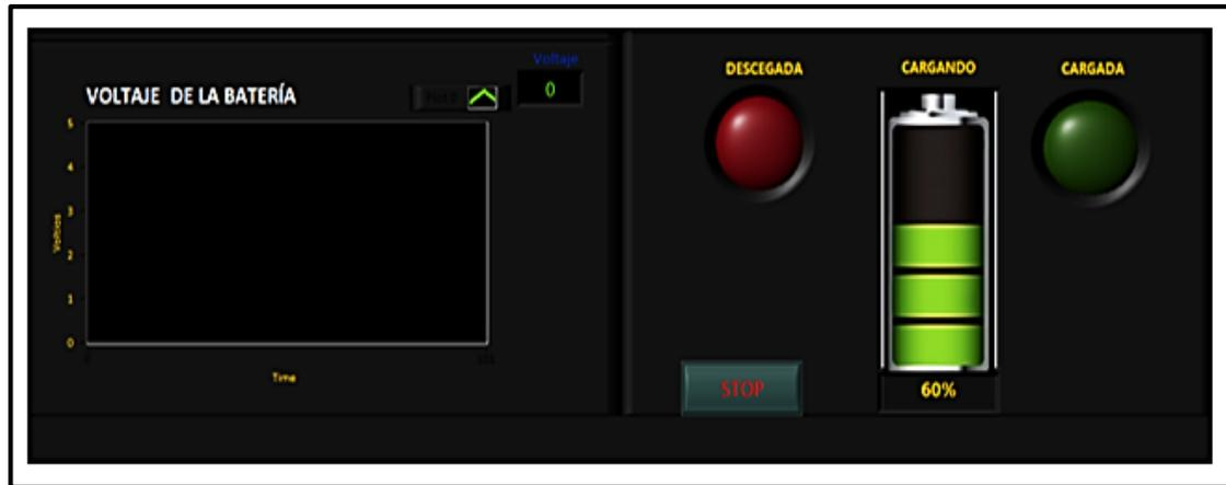
Figura 3.46. Panel frontal, control de nivel de la carga de batería del módulo móvil.
