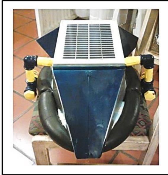
Figura 3.35. Sistema de Flotabilidad del módulo móvil acuático.
