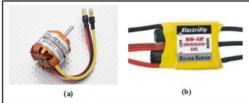
Figura 3.8. (a) Motor Brushless (b) Controlador de motor.
