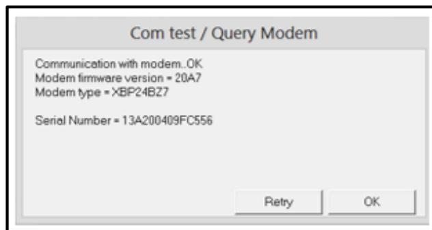
Figura 4.9. Software X-CTU, comprobación de la conexión.
