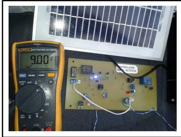
Figura 4.45. Medición del nivel de Voltaje, batería cargándose, pruebas de campo.
