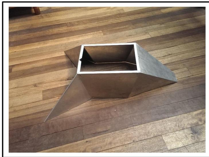
Figura 3.31. Ensamblaje de la estructura del chasis, del módulo móvil acuático.
