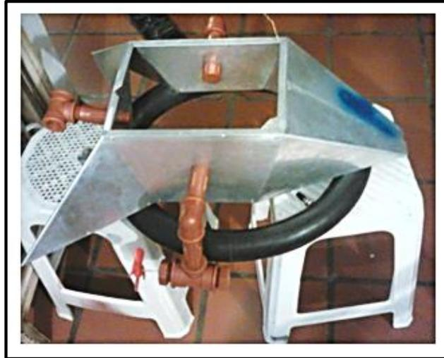
Figura 3.32. Ensamblaje de la estructura, soporte del chasis del módulo móvil acuático.
