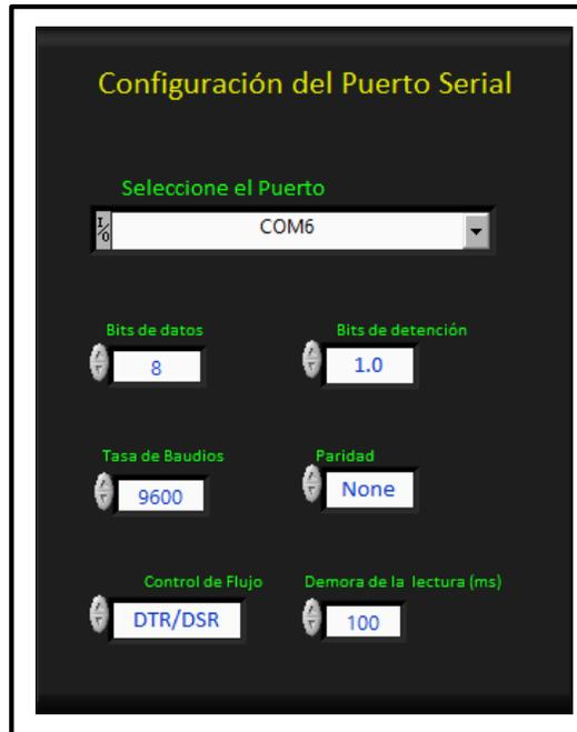
Figura 3.41. Panel frontal, configuración del puerto serial.
