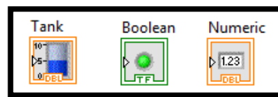
Figura3.8. Indicadores en el diagrama de bloques
