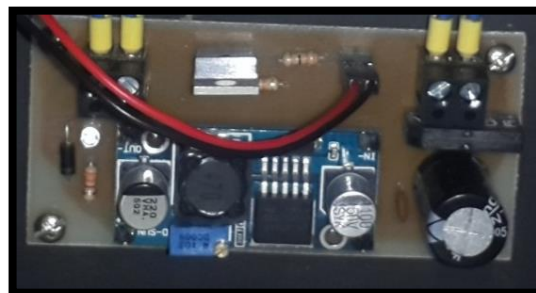
Figura 4.50: Placa de fuente regulable para control de disparo del solenoide
