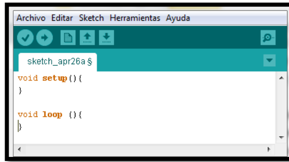
Figura 3.23. Estructura básica de la programación en Arduino
