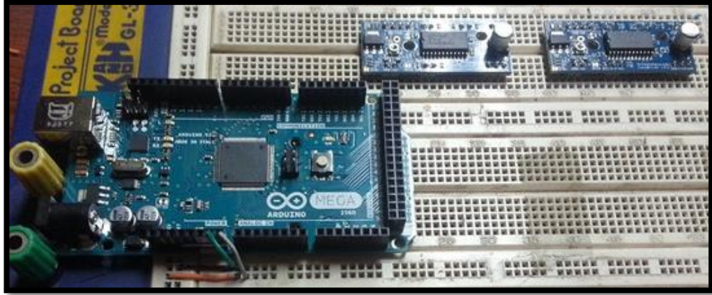
Figura 4.39: Montaje de ArduinoMega 2560 y drivers en protoboard
