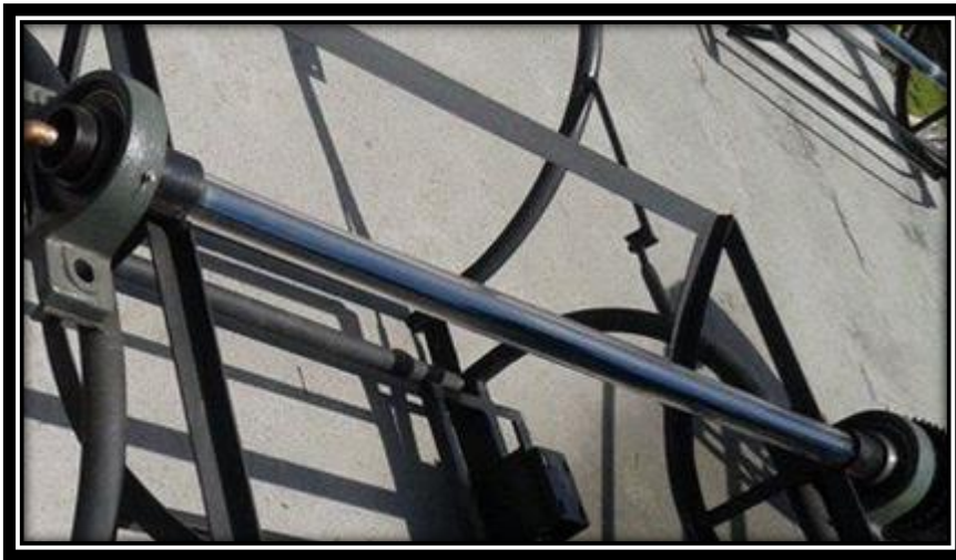
Figura 2.12 Tubo receptor en el centro de la parábola Fuente: Autor
