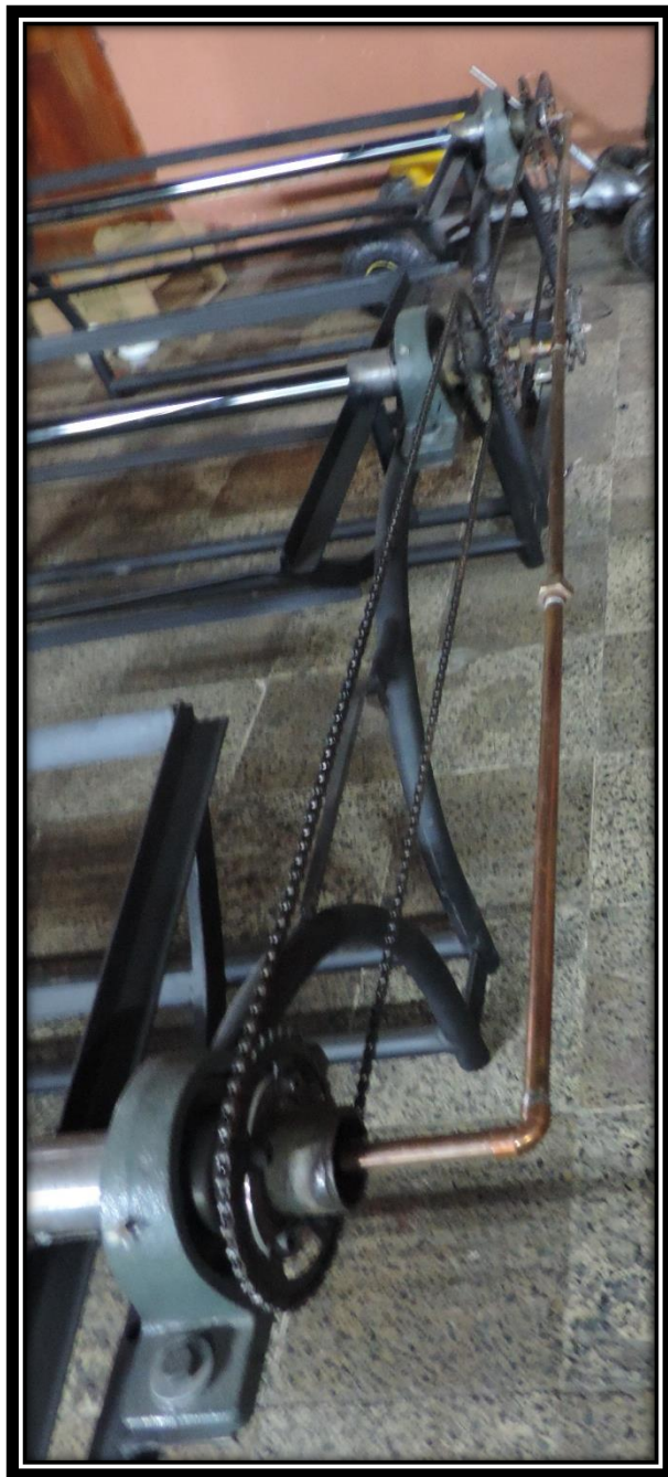
Figura 2.11 Sistema de transmisión de movimiento Fuente: Autor
