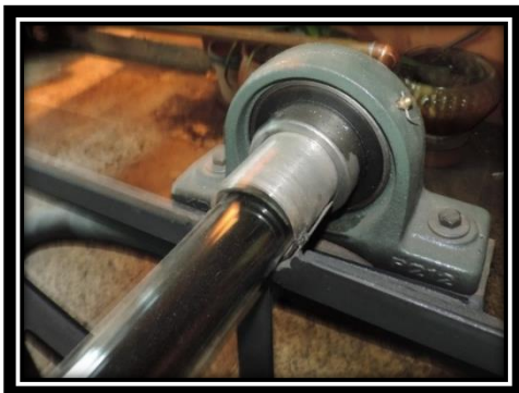
Figura 2.13 Sujeción del tubo en la chumacera Fuente: Autor
