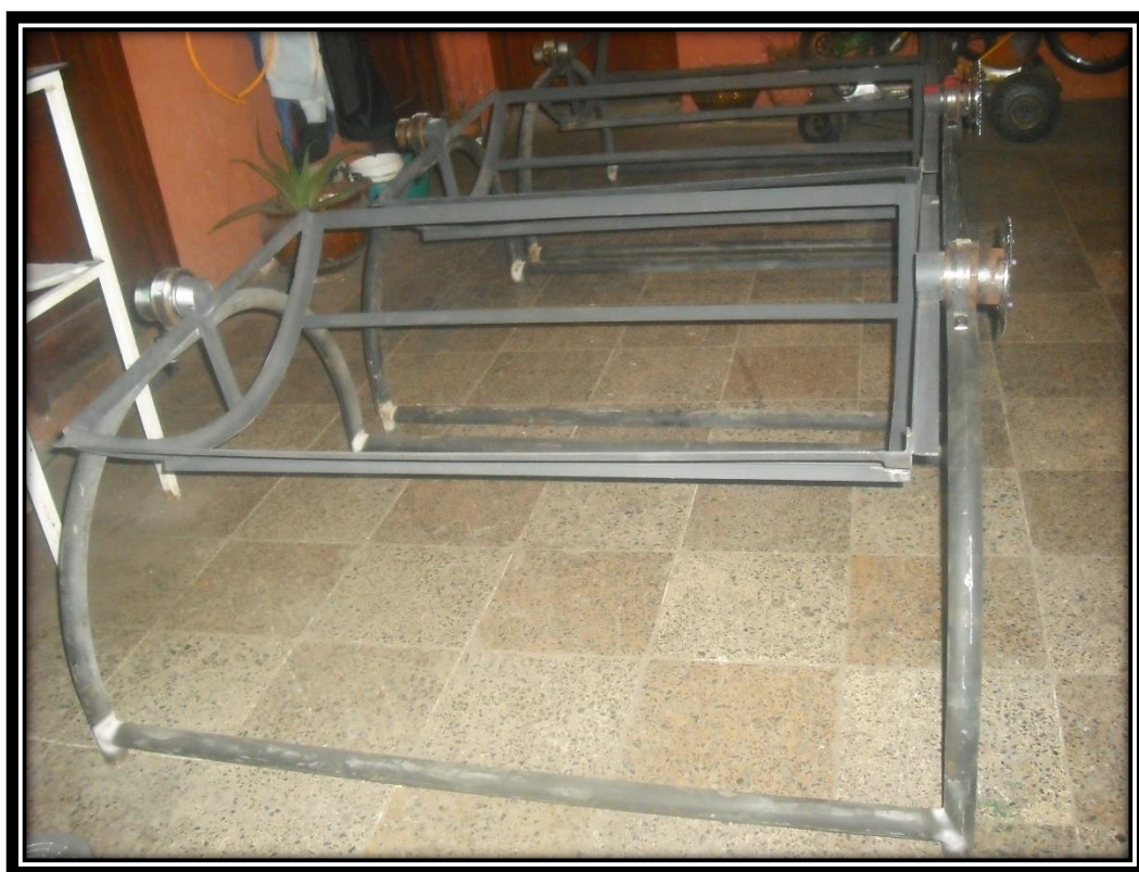
Figura 2.10 Ensamblaje del sistema de concentradores cilindro parabólicos Fuente: Autor
