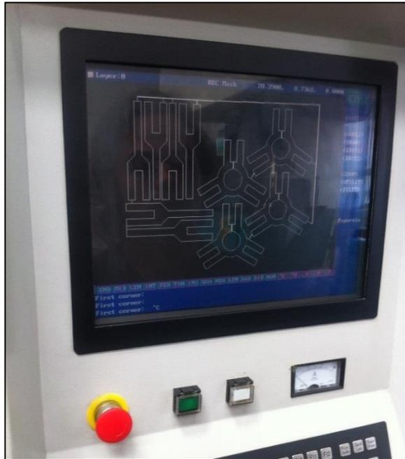
Figura 24 Interfaz gráfica donde se aprecia el avance del corte
