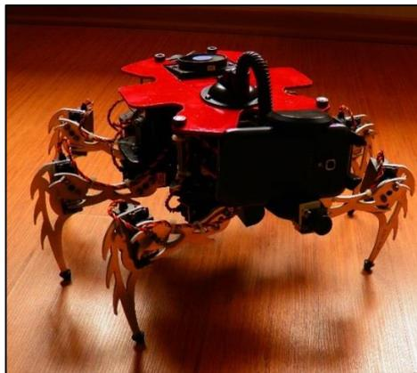
Figura 6 Robot del tipo walking (hexápodo)
