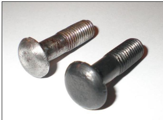
Figura 42 Diferencia entre tornillo en poseso de oxidación y tornillo pavonado
