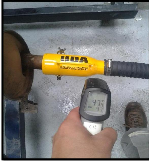
Figura 77: Temperatura de acople
