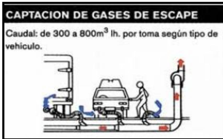
Figura 36: Ventiladores para evacuar gases
