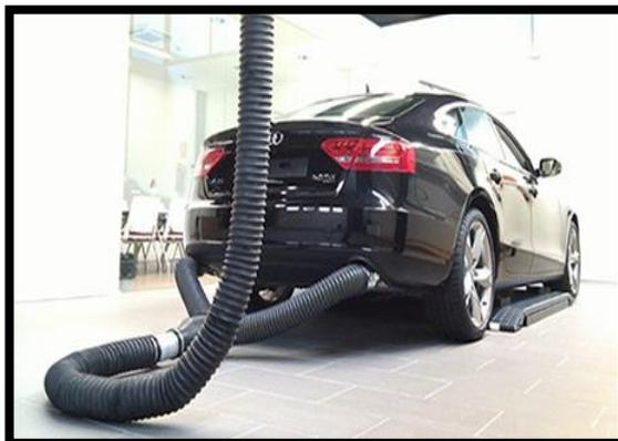
Figura 40: Acople de tubería en salida de escape
