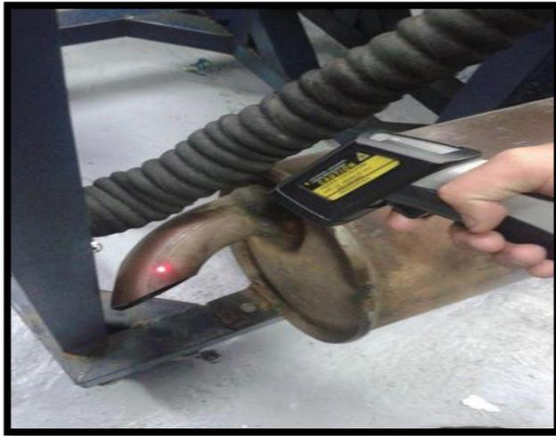
Figura 41: Medición de Temperatura de los Gases de Escape.
