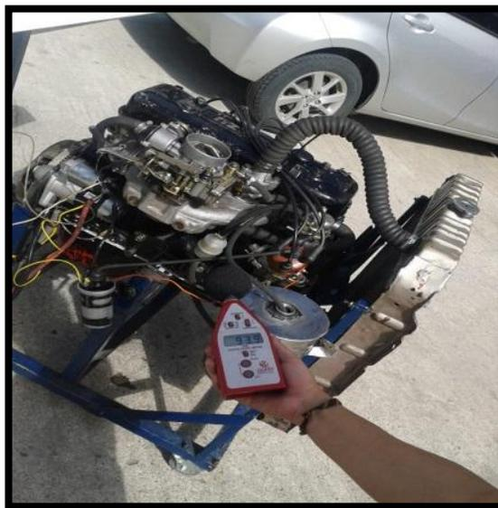
Figura 13: Medición de nivel de ruido.
