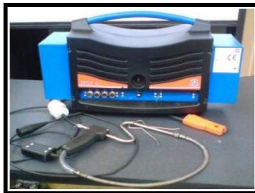
Figura 5: Analizador de gases MAHA MGT 5
