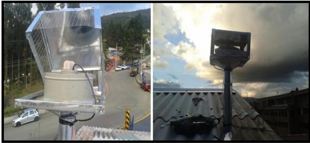
Figura 58: Implementación de chimenea y extractor
