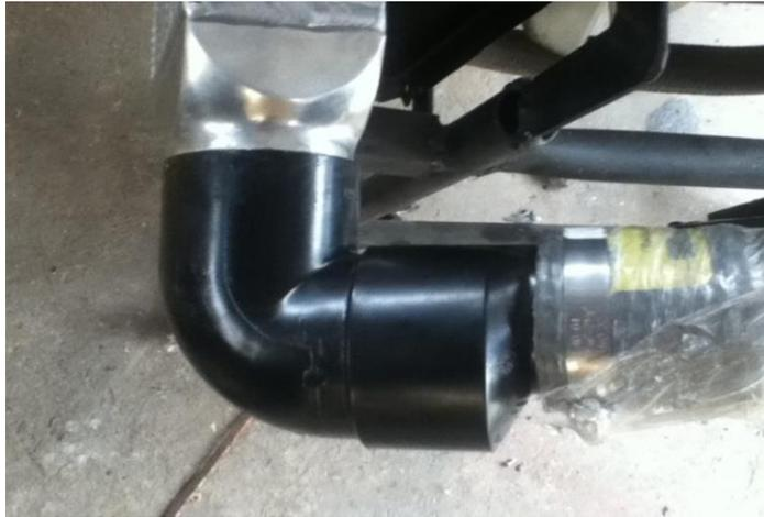
Fig. 4.15. Acople y reducción en la boca del intercooler.
