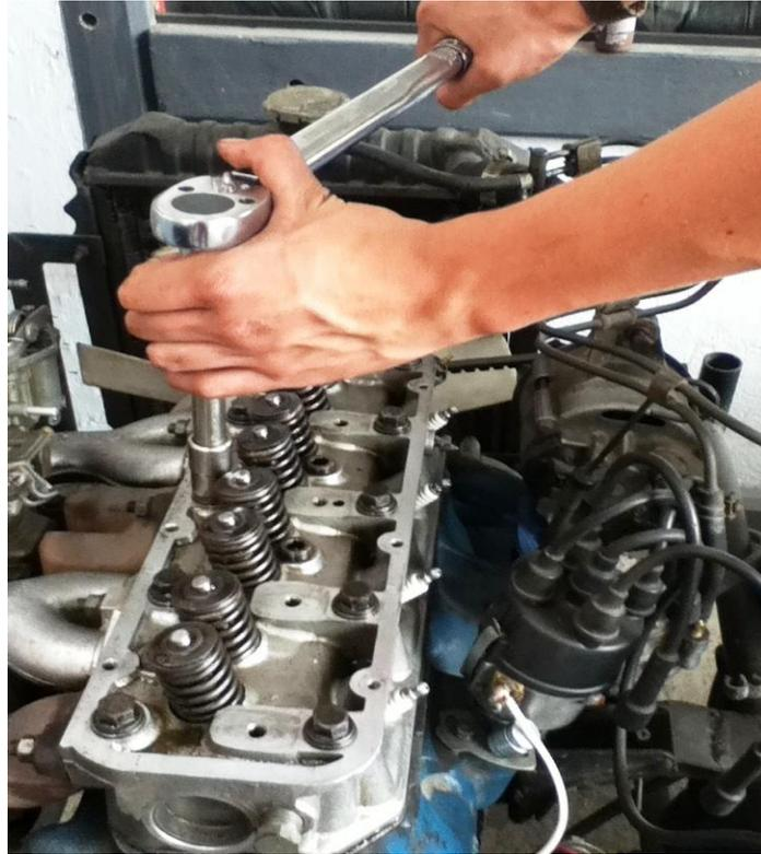
Fig. 4.6. Montaje del cabezote.
