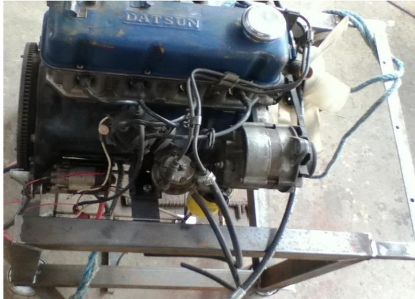
Fig. 4.3 Motor montado sobre las bases de la estructura
