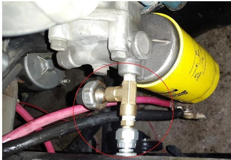
Fig. 4.10. Acople en T para la manguera de lubricación del turbocompresor.
