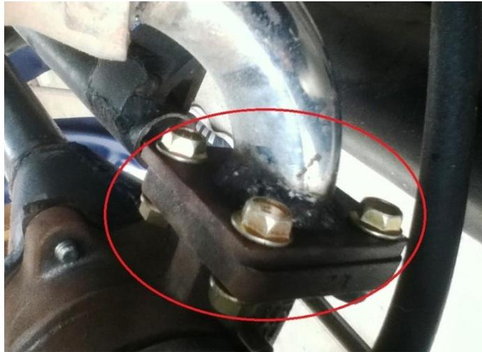
Fig. 4.8. Base en el múltiple de escape para el montaje del turbocompresor.
