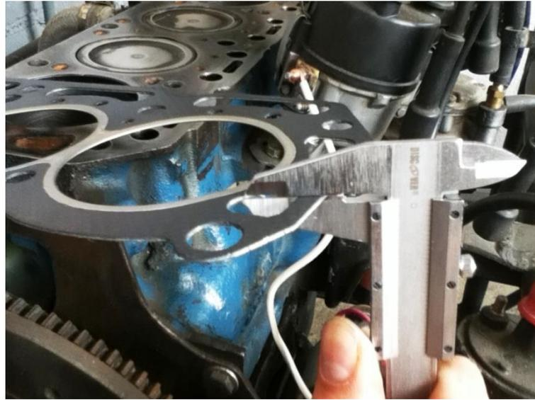
Fig. 3.4. Medición del espesor del empaque del cabezote.
