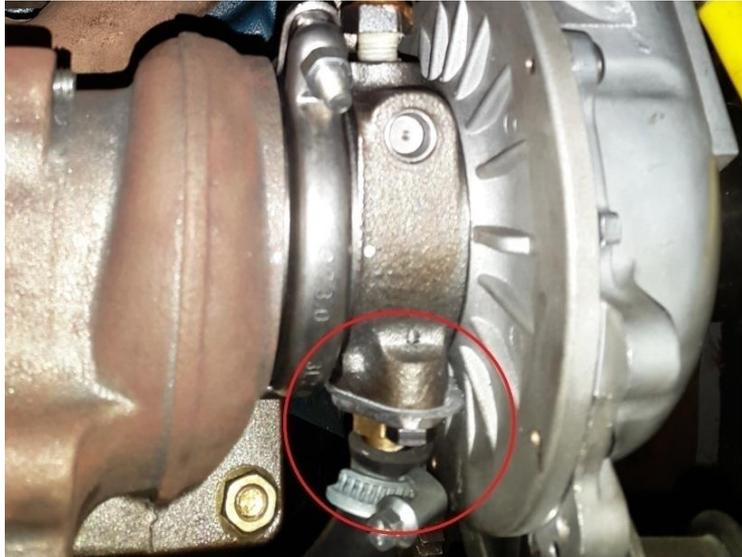
Fig. 4.13. Retorno de aceite del turbocompresor.
