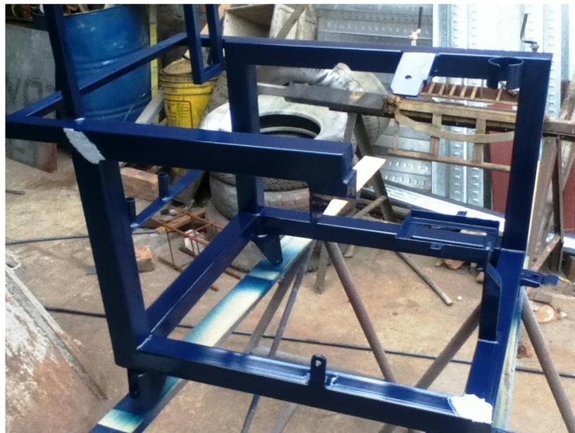
Fig. 4.4 Estructura metálica terminada y pintada.
