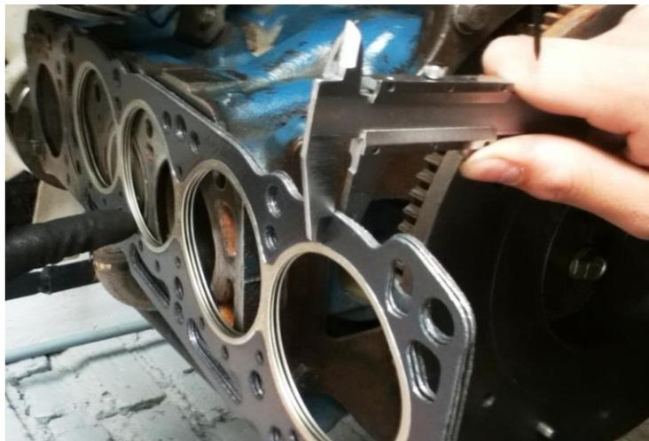
Fig. 4.5. Medición del espesor de los 3 empaques del cabezote.
