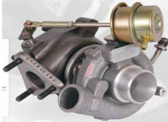
Fig. 3.9. Turbocompresor GT1241.
