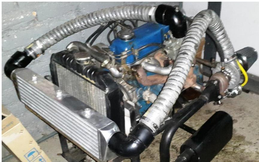
Fig. 4.16. Intercooler y mangueras de aire instaladas en el motor con turbocompresor.
