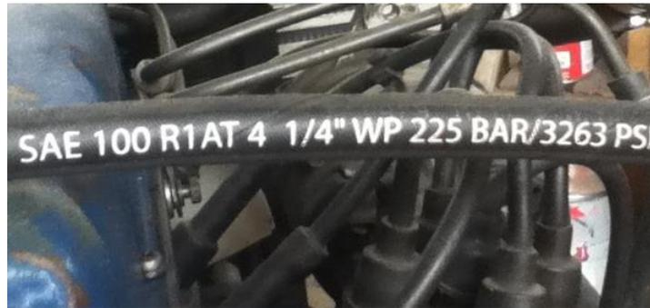
Fig. 4.9 Manguera de alta presión para lubricación del turbocompresor.
