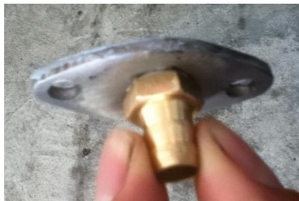
Fig. 4.12. Acople para el retorno de aceite del turbocompresor.
