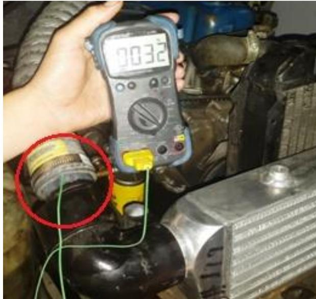
Fig. 4.17. Medición de la temperatura de aire a la salida del intercooler.
