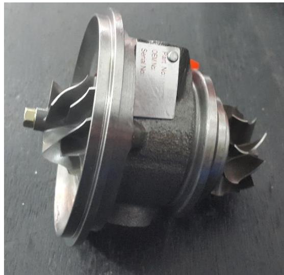
Fig. 3.13. Rodetes del turbocompresor RHF4.
