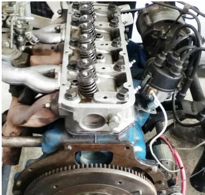
Fig. 4.7. Motor Nissan A-12 con relación de compresión modificada.
