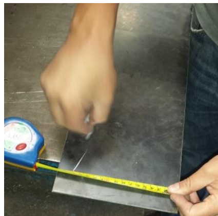
Figura 3.8. Medición de material para obtener los brazos de sujeción
