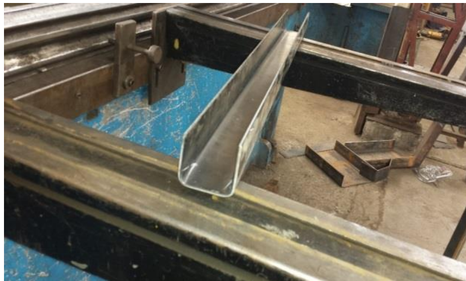
Figura 3.12. Obtención de la segunda cara doblada
