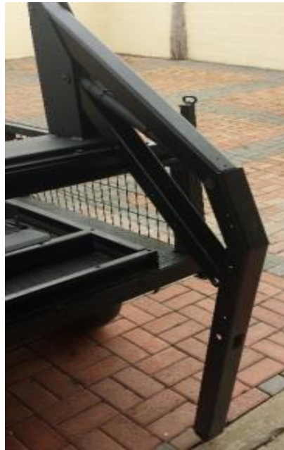
Figura 3.25. Ensamblaje brazos B-E y A-D
