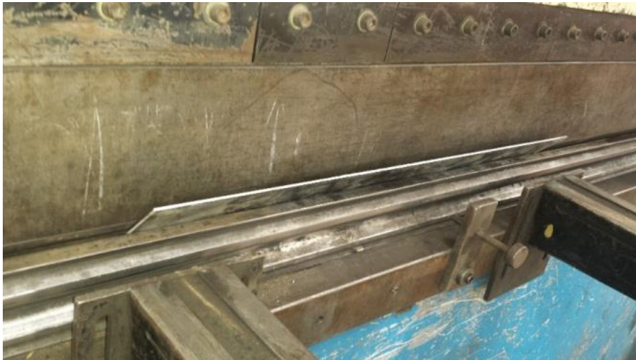
Figura 3.10. Doblado de la plancha
