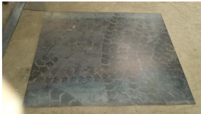
Figura 3.6. Plancha de acero A36
