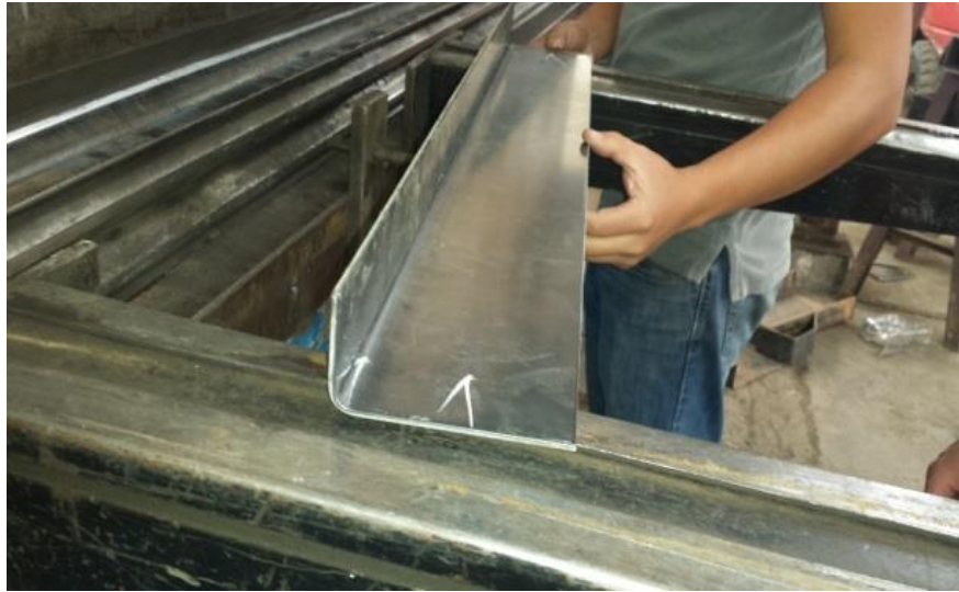
Figura 3.11. Obtención de la primera cara doblada
