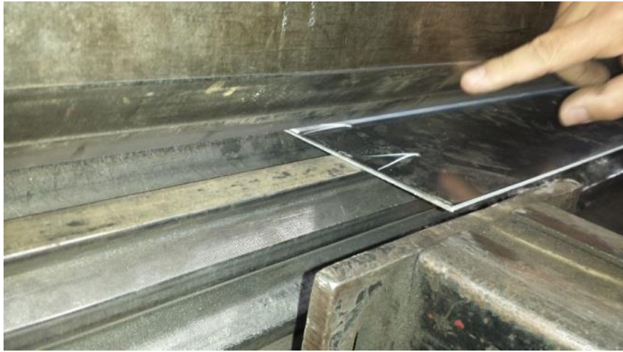
Figura 3.9. Ubicación de la plancha en la maquina dobladora
