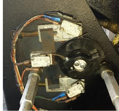
Figura 3.37. Funcionamiento de la leva e interruptores de final de carrera
