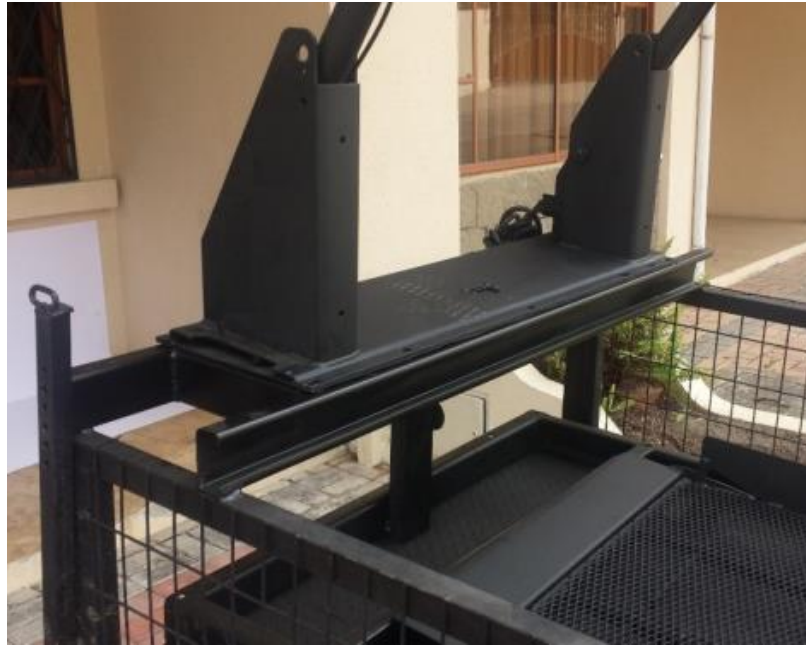
Figura 3.21. Sujeción de la base del dispositivo en el bastidor
