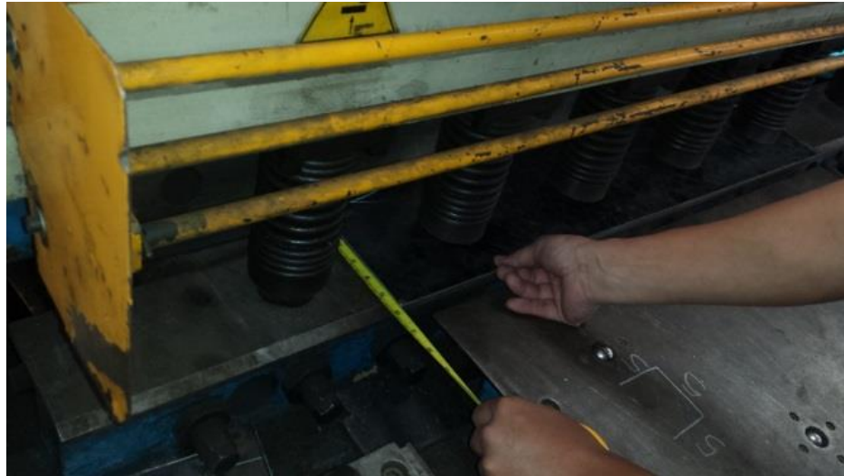
Figura 3.7. Proceso de cortado de la plancha
