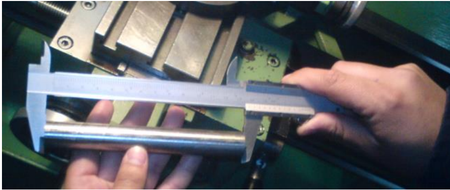
Figura 3.17. Medición de material
