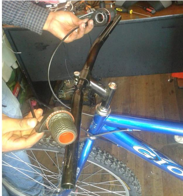
Figura 3. 17 Montaje de frenos
