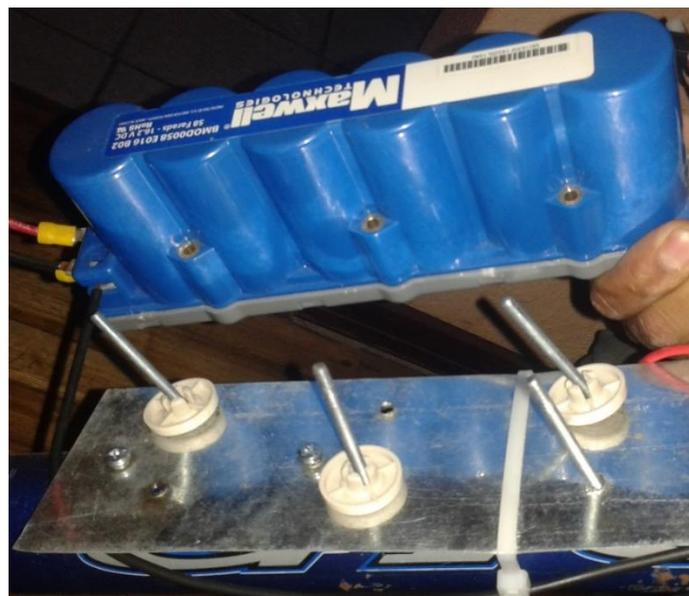
Figura 3. 23 Montaje de los SC
