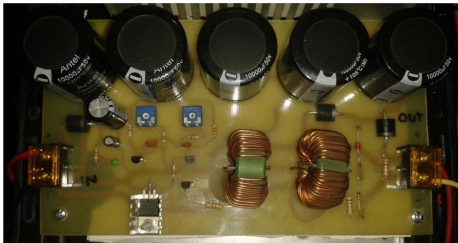
Figura 3. 13 Conversor construido
