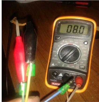
Figura 2. 4 Medición de resistencia.
