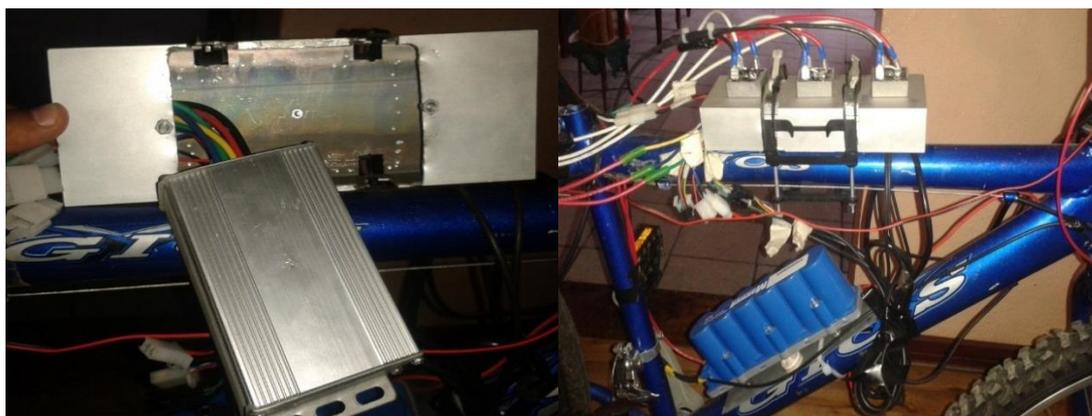
Figura 3. 20 Orificio dela caja de aluminio (2) Montaje de la ECU y diodos rectificadores
