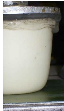
Figura 3.4: El tampón desplaza sus bordes sobre el cliché
