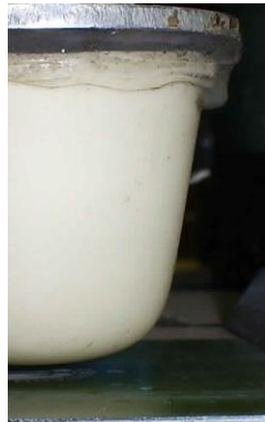
Figura 3.3: Tampón antes de hacer contacto con el cliché
