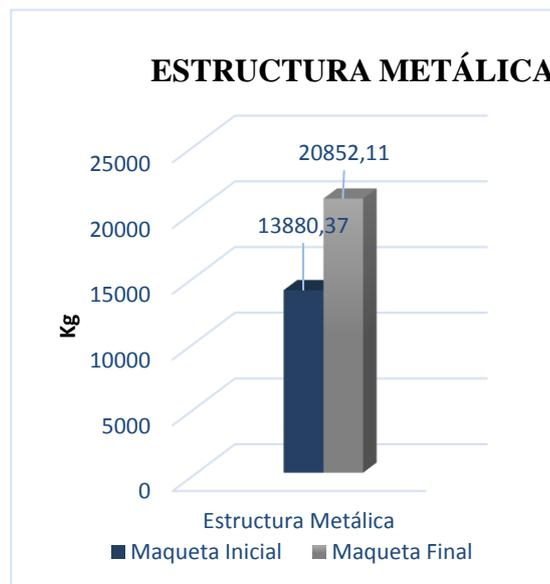
Figura 83.-Comparación de la variación del peso de estructura metálica entre maqueta inicial y final
