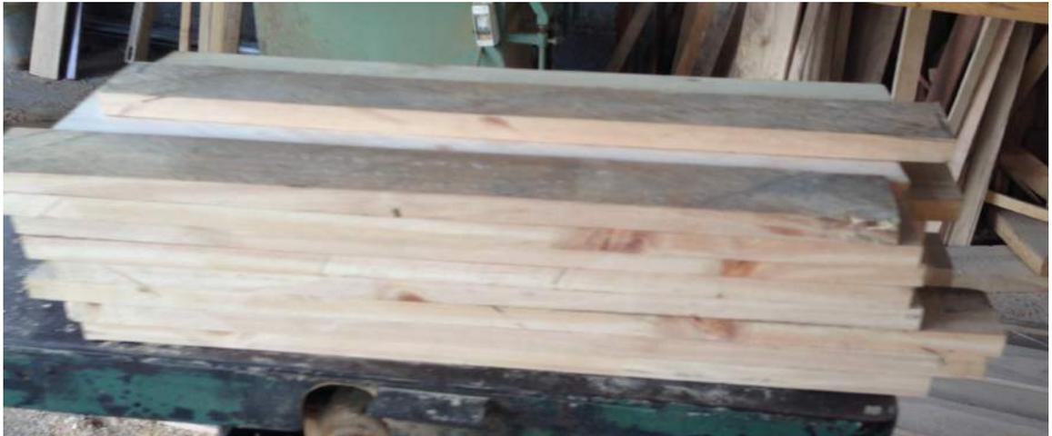
Fig. 4.1.16 Fotos de probetas para ensayos de flexión
