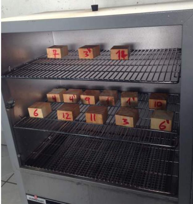
Fig. 4.1.19 Fotos de probetas para determinar la humedad
