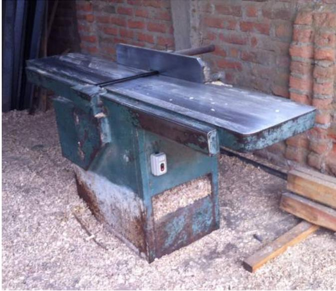
Fig. 4.1.3 Canteadora, Maquinaria para mecanizar madera
