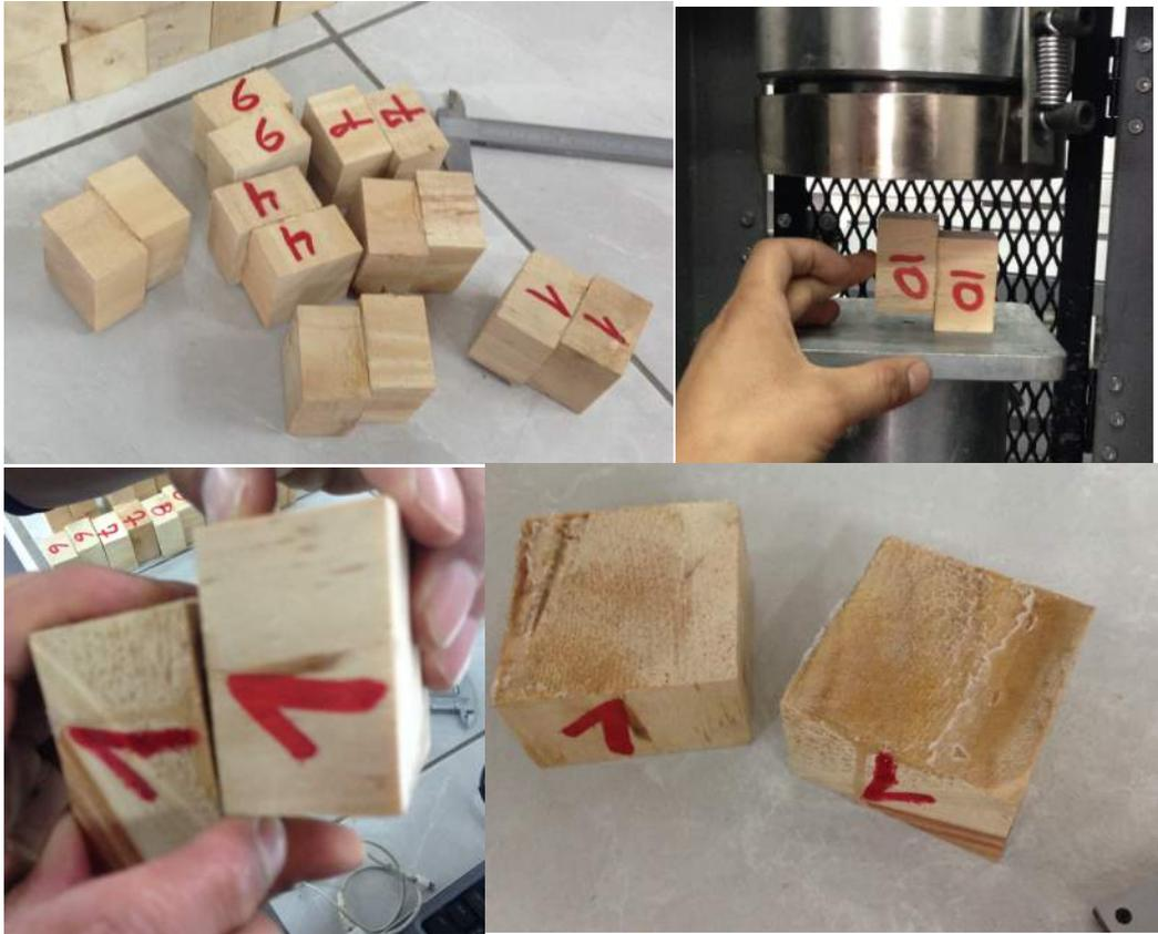
**Fotografías de ensayos para determinar contenido de humedad y densidad**
