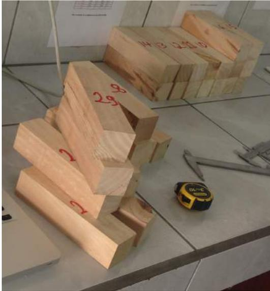
Fig. 4.1.14 Foto de probetas para ensayos de compresión
