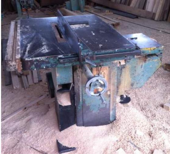
Fig. 4.1.5 Sierra circular, maquinaria para mecanizar madera
