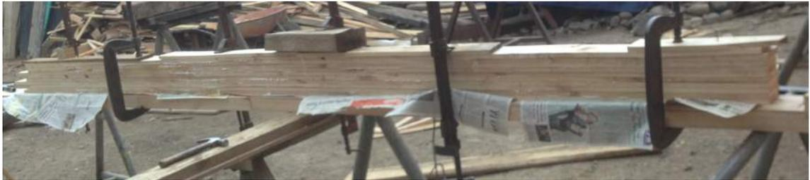
Fig. 4.1.1 Elaboración de viga, que consta de 10 láminas
