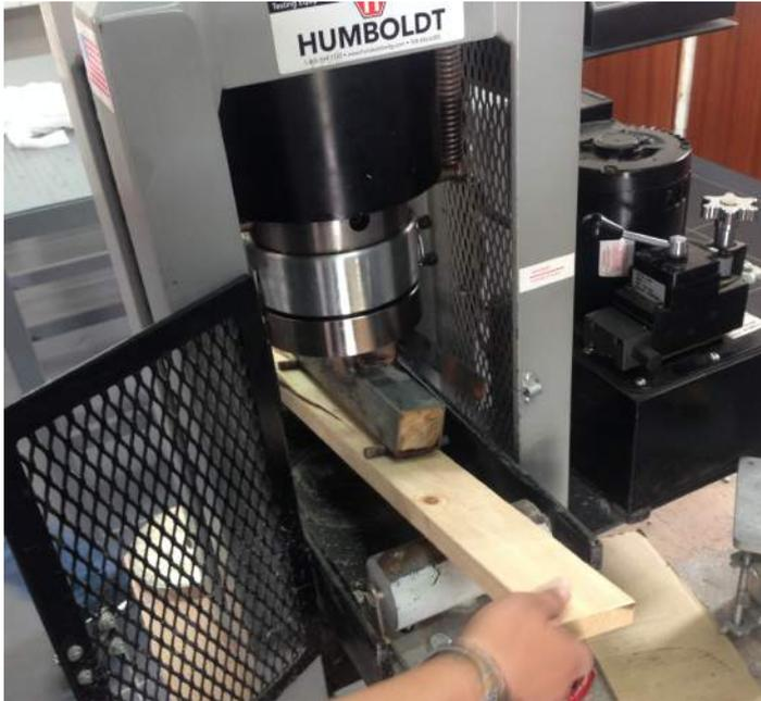
Fig. 4.1.18 Foto de ensayo de Flexión
