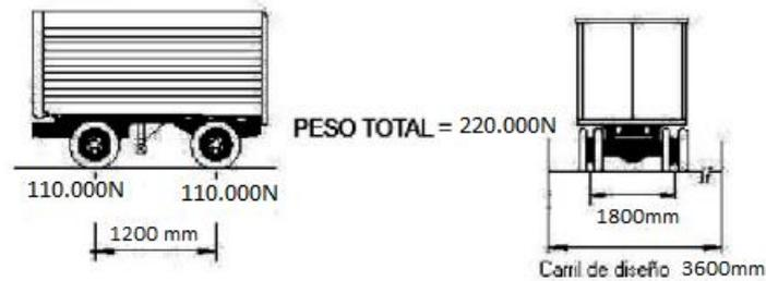
Figura #3.2: Tandem de diseño.
