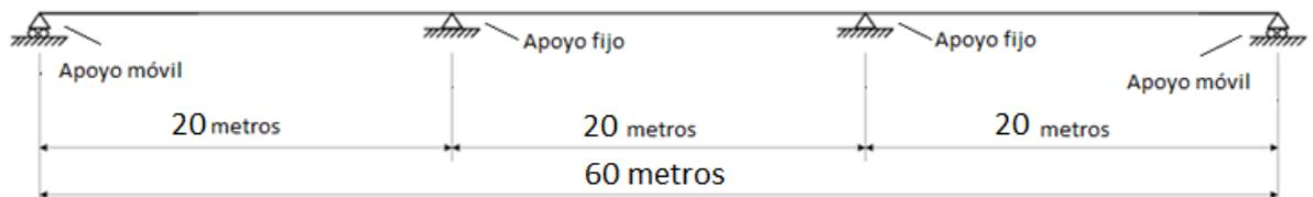
Figura #4.1: Modelo básico del puente de 3 tramos vista longitudinal.
