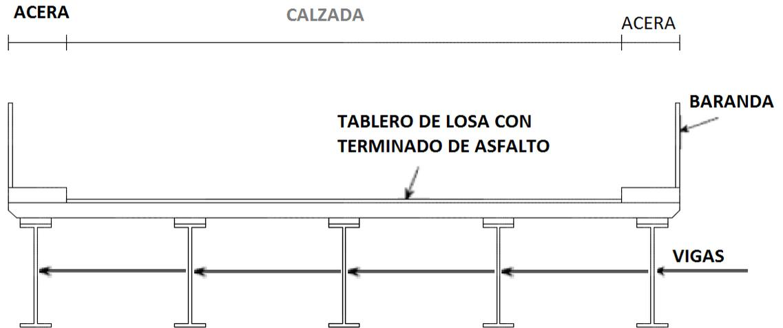
Figura #1.1: Modelo básico de una superestructura de viga de acero y losa de hormigón armado.
