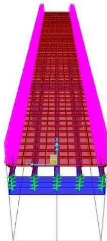
Figura #4.12: Carga de area peatonal aplicada en 0,75m a cada extremo del puente.
