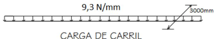
Figura #3.3: Carga de carril de diseño.
