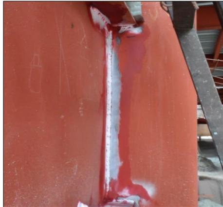
Figura 4-8: Soldadura aprobada por tintas penetrantes en obra
