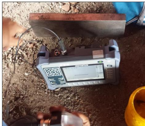
Figura 4-10: Bloque de calibración según AWS D 1.1 /D1.1 M 2010 en obra
