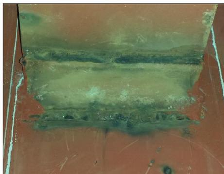
Figura 4-3: Soldadura rechazada visualmente
