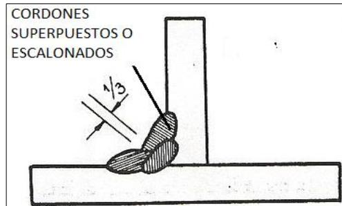
Figura 1-12: Sección de cordones superpuestos o escalonados
