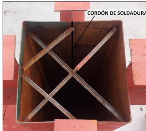
Figura 1-8: Rigidizadores de montaje para columna compuesta
