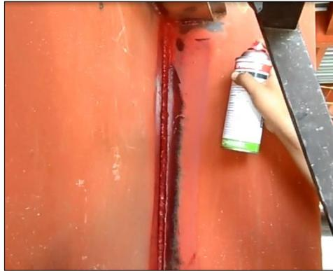
Figura 4-6: Aplicación de penetrante en obra
