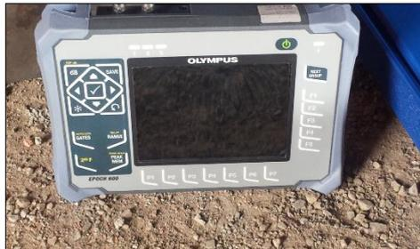
Figura 4-9: Ultrasonido en Olympus Serie EPOCH 1000 en obra
