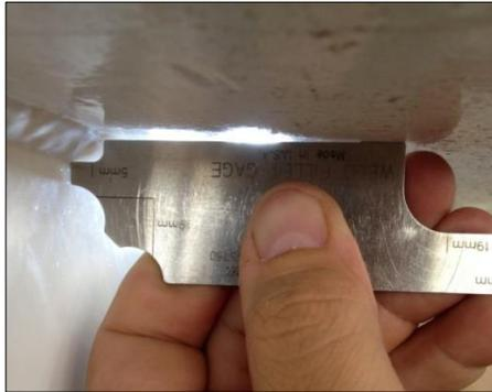
Figura 4-2: Medición de soldadura de filete
