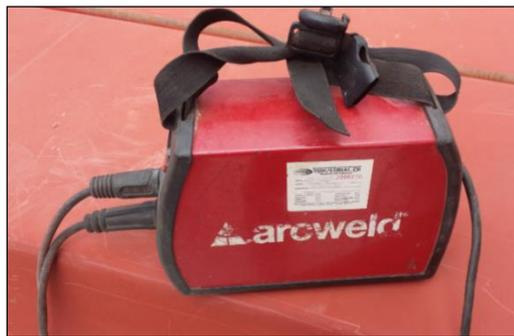
Figura 1-14: Soldadora marca Arcweld empleada en obra
