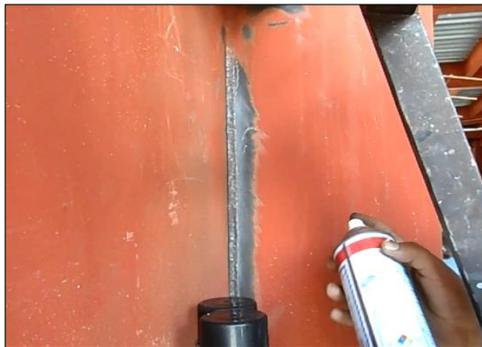
Figura 4-5: Aplicación de removedor en obra
