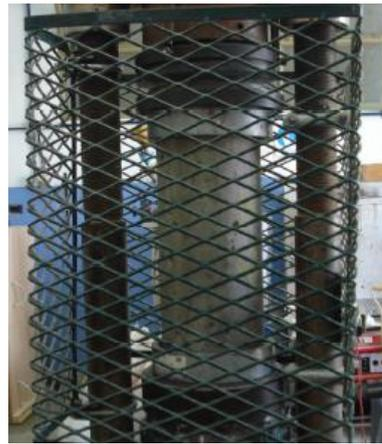
Figura 3-6: Equipo para determinar el valor por rotura de compresión en un cilindro de hormigón
