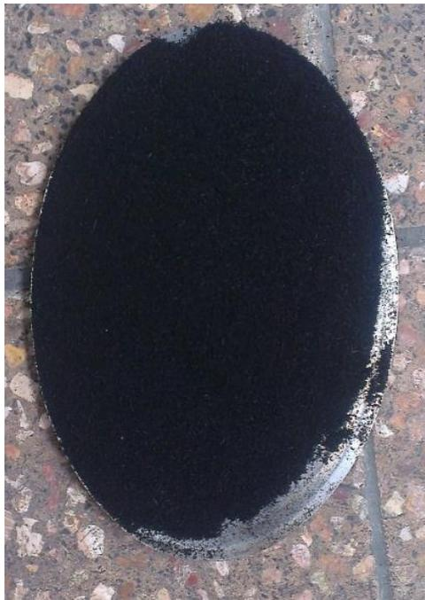
Figura 3-24: Viruta de caucho obtenida por tamizado
