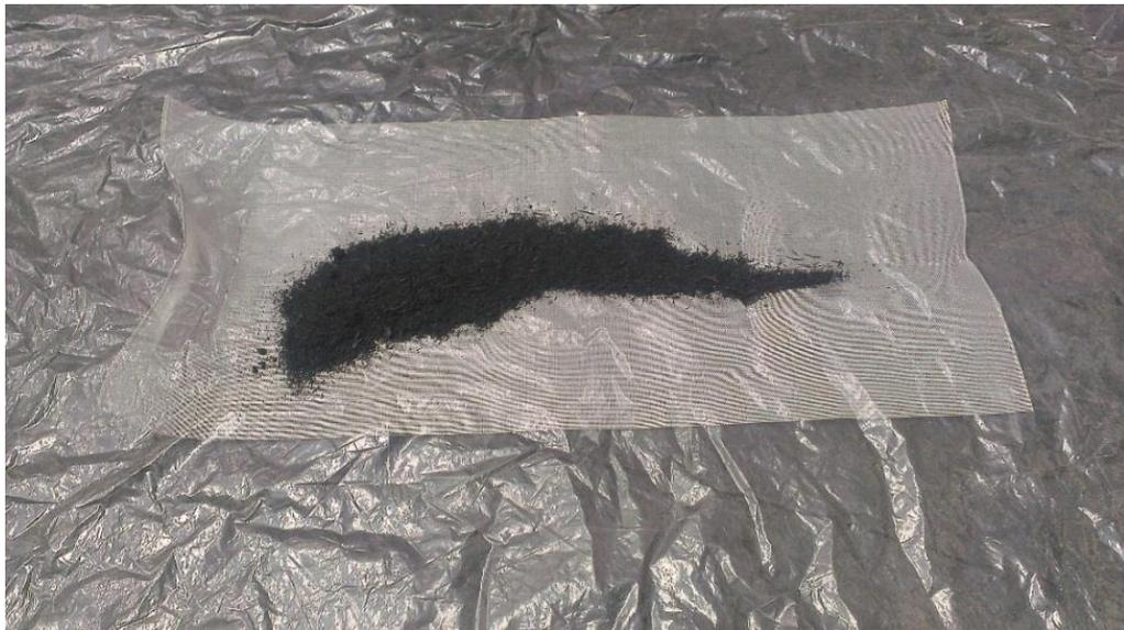
Figura 3-22: Material (viruta de caucho) sin tamizar
