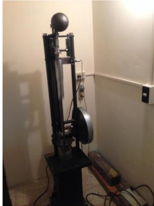
Figura 3-8: Compactador automático para confección de briquetas
