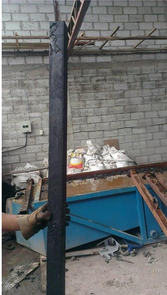
Figura 3-3: Poste de sección rectangular con dosificación de 80% de plástico ABS y 20% de material de neumáticos
