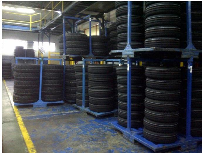
Figura 31. Almacenaje en racks de llantas PLT radial y convencional
