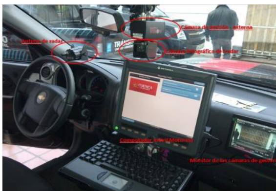
Fotografía 7: Radares de detección de velocidad con capacidad de operar de forma estacionaria o en movimiento
