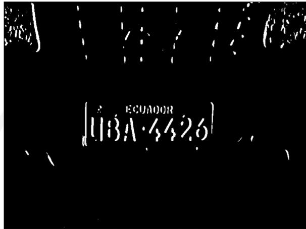
Figura 3.37: Procesamiento: operador Sobel para detección de bordes verticales.
