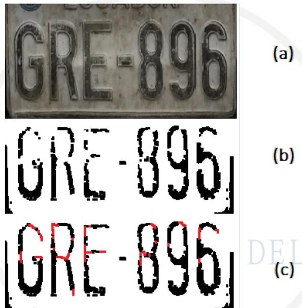
Figura 4.18: Ejemplo de una placa en mal estado, binarizada y reformada.
