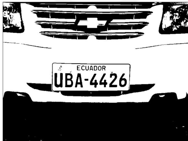
Figura 3.36: Procesamiento: Otsu threshold
