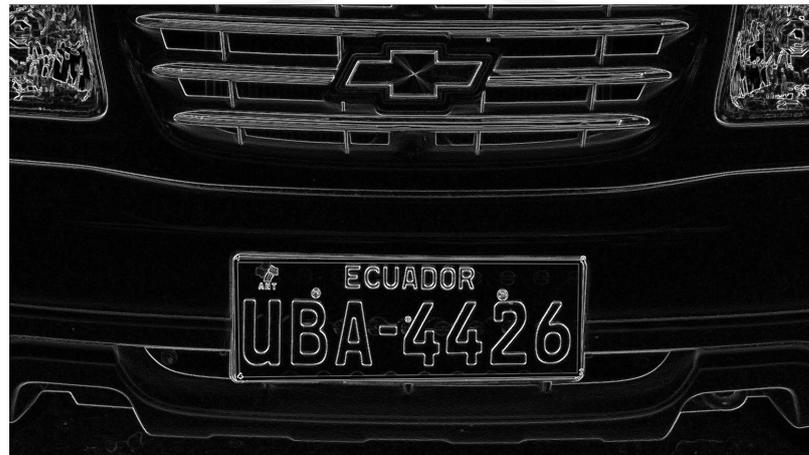
Figura 2.6: Efecto de la aplicación del operador de Sobel en los bordes en una imagen de entrada.
