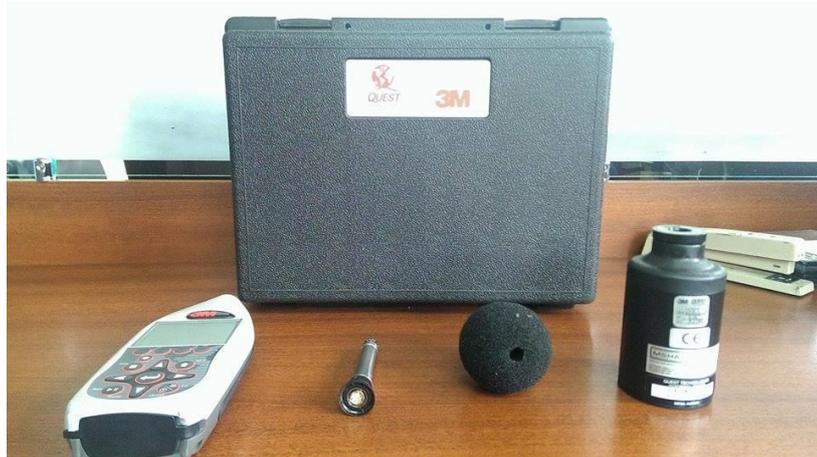
Figura 7.4. Equipamiento del sonómetro 3M Quest SoundPro.
