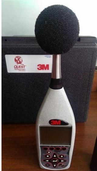
Figura 5.11. Sonómetro 3M Quest SoundPro.
