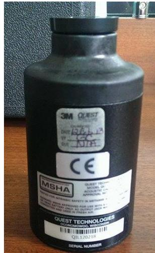
Figura 7.5. Calibrador del sonómetro.
