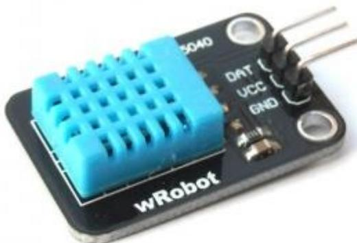
Figura 5.6. Sensor de temperatura y humedad DHT11 de la marca wRobot.
