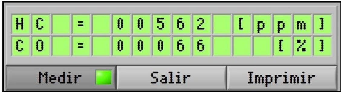
Figura 46 Panel Frontal del Instrumento Virtual.
