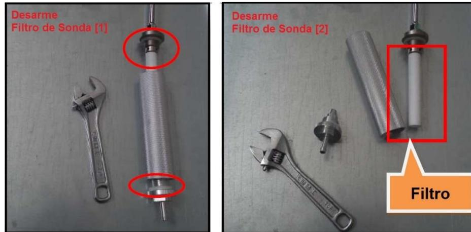
Figura 2.25 Sonda, proceso de cambio de filtro.
