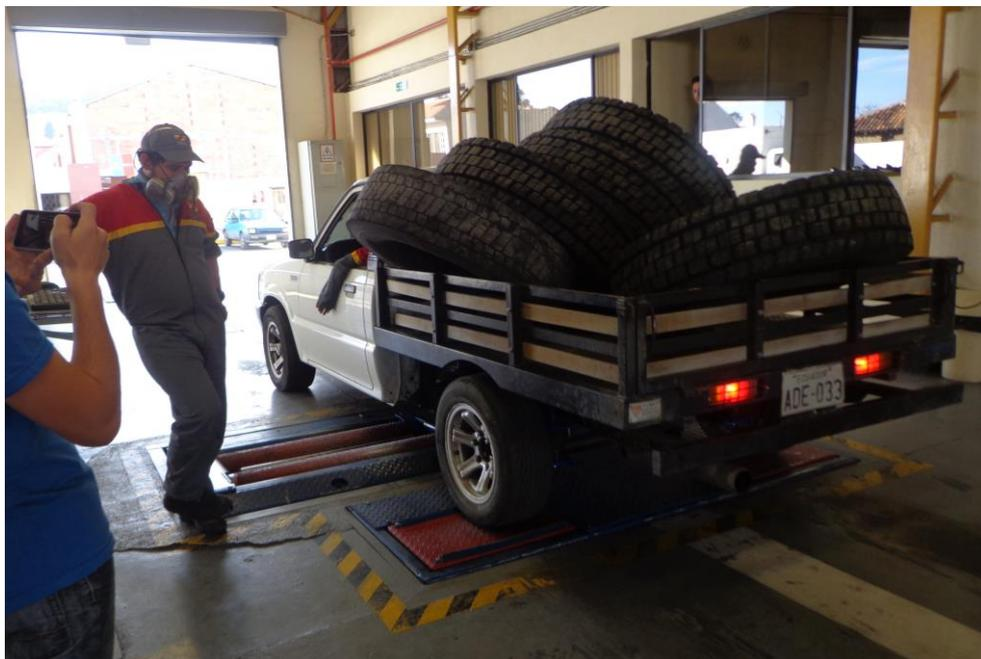
Figura 4.4 Prueba de suspensión de sistema neumático con carga.
