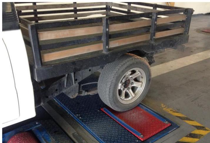
Figura 4.2 Prueba de suspensión de sistema de ballestas sin carga.
