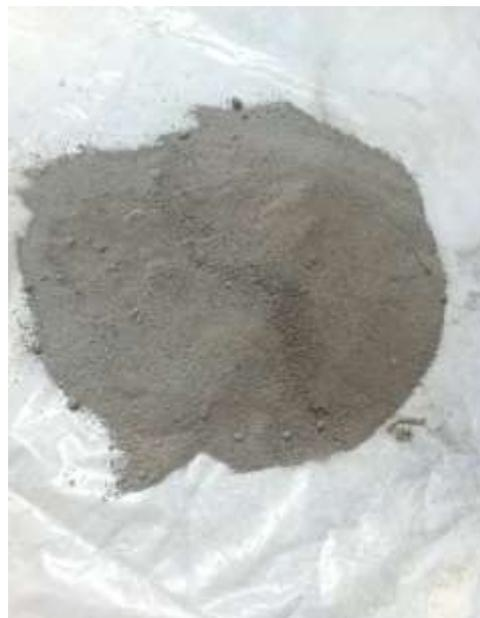
Figura 11: Mezcla de áridos y cemento
