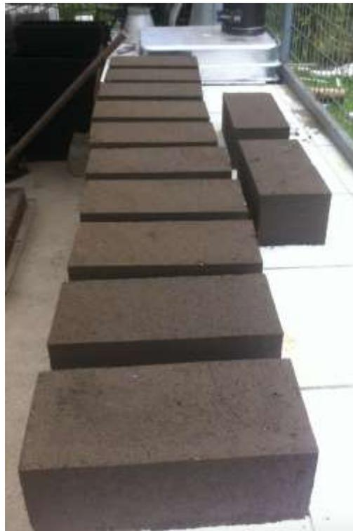
Figura 22: Bloques de suelo cemento ML y CL
