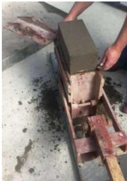
Figura 18: Bloque suelo cemento terminado
