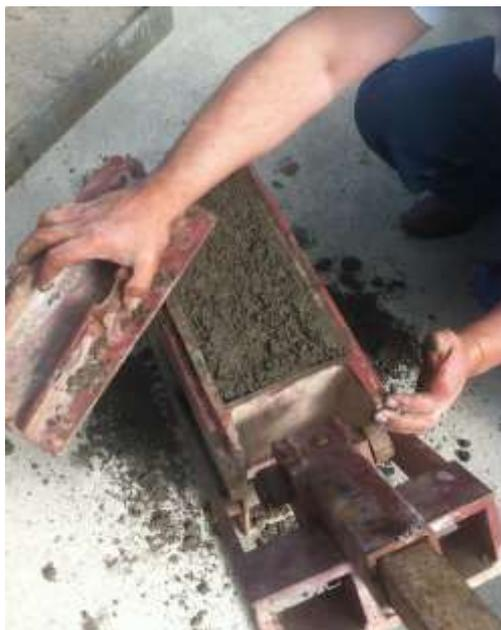
Figura 15: Relleno de prensa y quitado de exceso de mezcla
