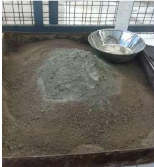
Figura 10: Dosificación de los áridos y el cemento por volúmenes
