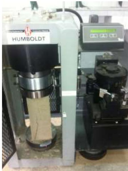
Figura 21: Rotura de bloque de suelo cemento
