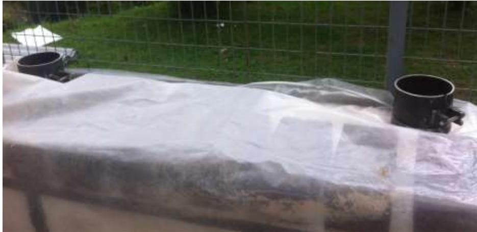
Figura 19: Curado de bloques de suelo cemento
