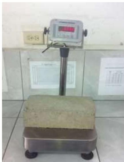
Figura 20: Pesaje de bloque de suelo cemento
