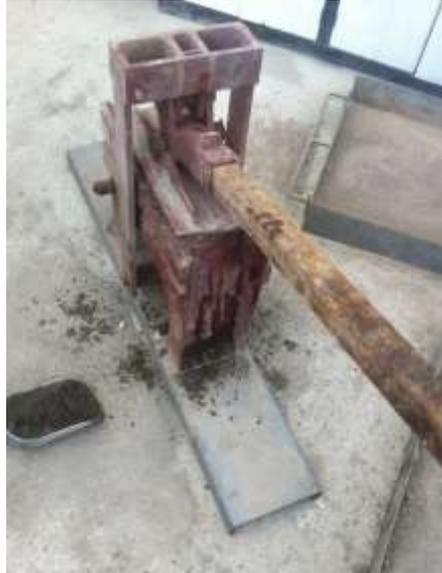
Figura 17: Prensado de bloque suelo cemento
