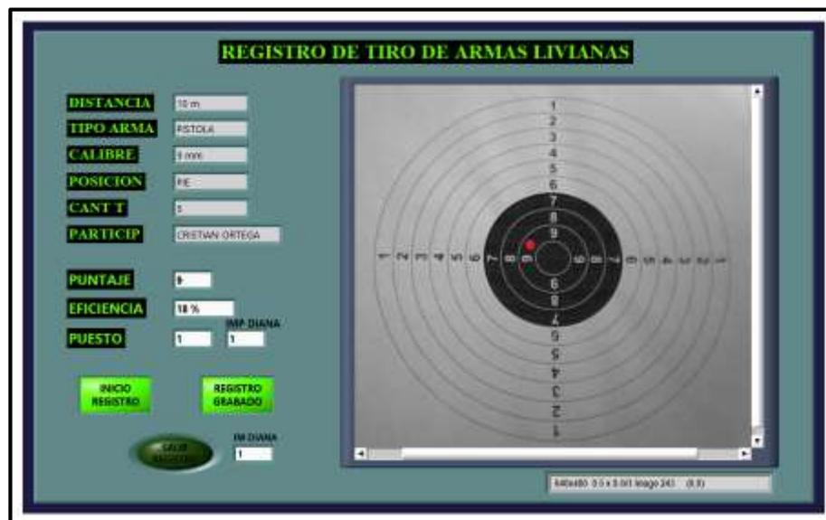
Figura 3.41. Panel frontal del dispositivo, captura de impacto
