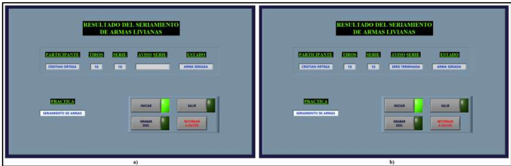
Figura 3.21. Panel frontal de la consola: a) arma seriada. b) serie terminada
