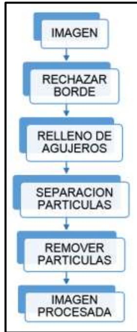
Figura 2.44. Esquema para la aplicación de morfología en una imagen
